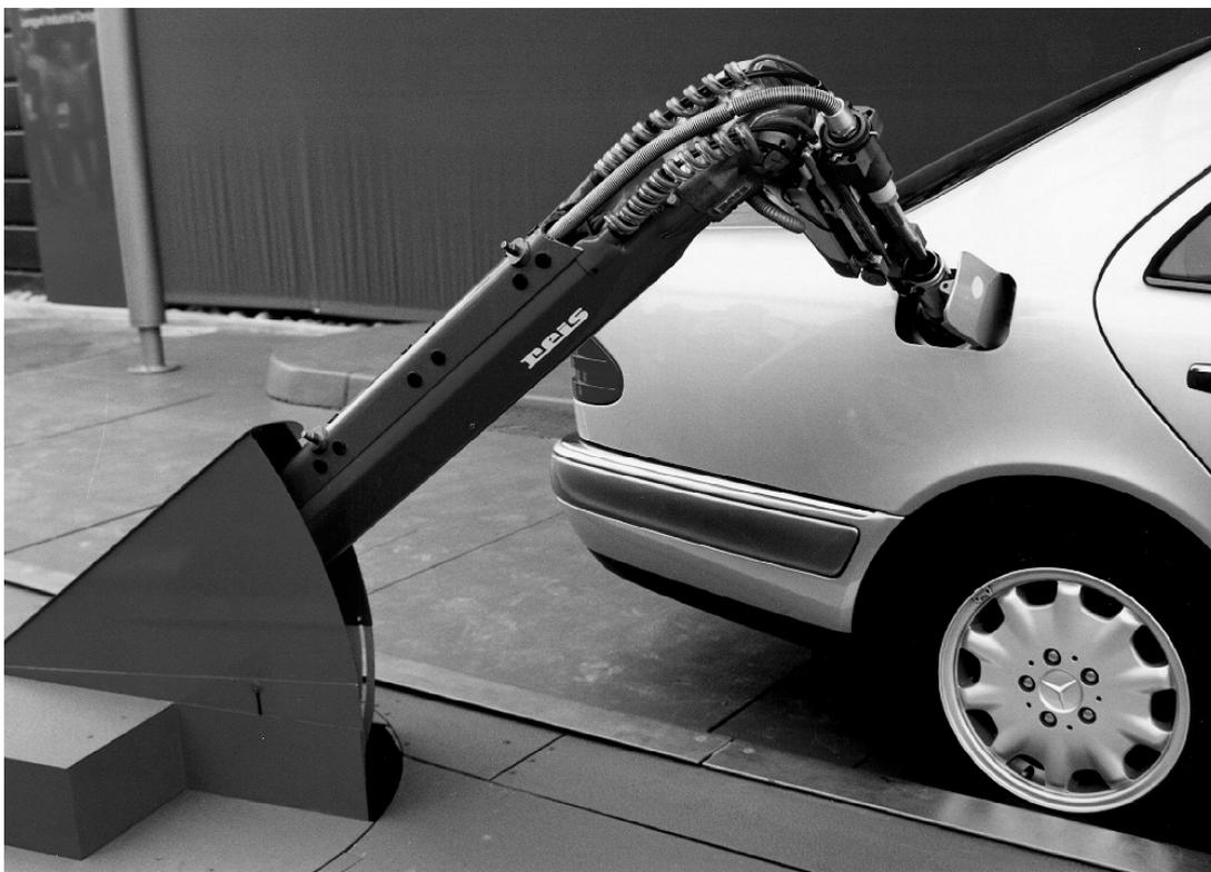
Abb. 7-5: Forschungsprojekt Robottanken [STE95]
