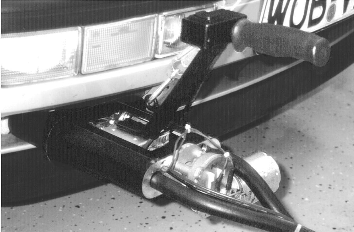
Abb. 8-16: Manueller Kupplungskopf
