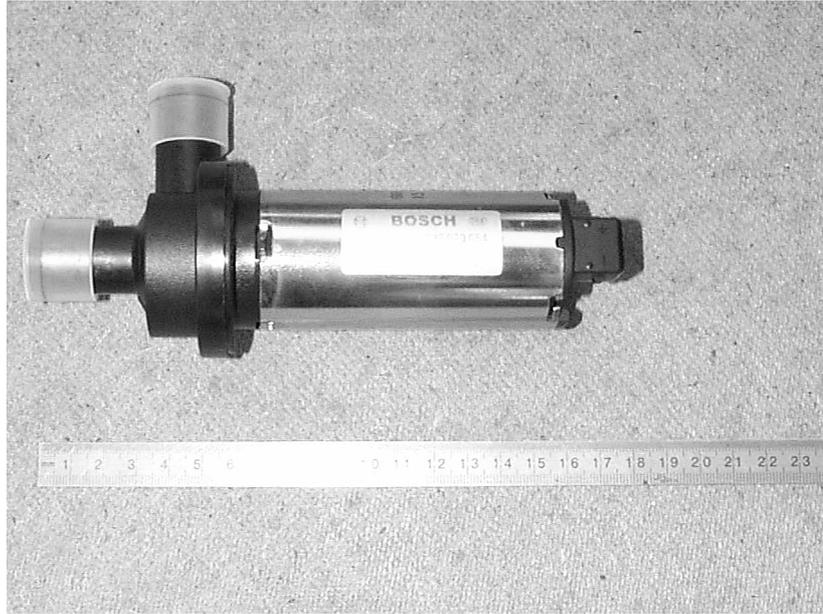
Abb. 8-20: Kühlwasserumwälzpumpe
