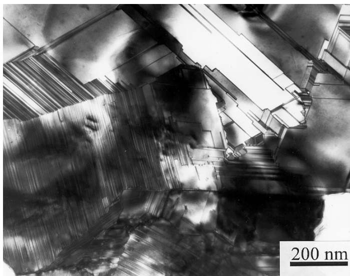
Abbildung 30: Aufsicht auf ein Korn einer poly-Si-Schicht auf Glas mit TEM. Die Körner enthalten Defektdichten von > 10^8 \text{ cm}^{-2} .
