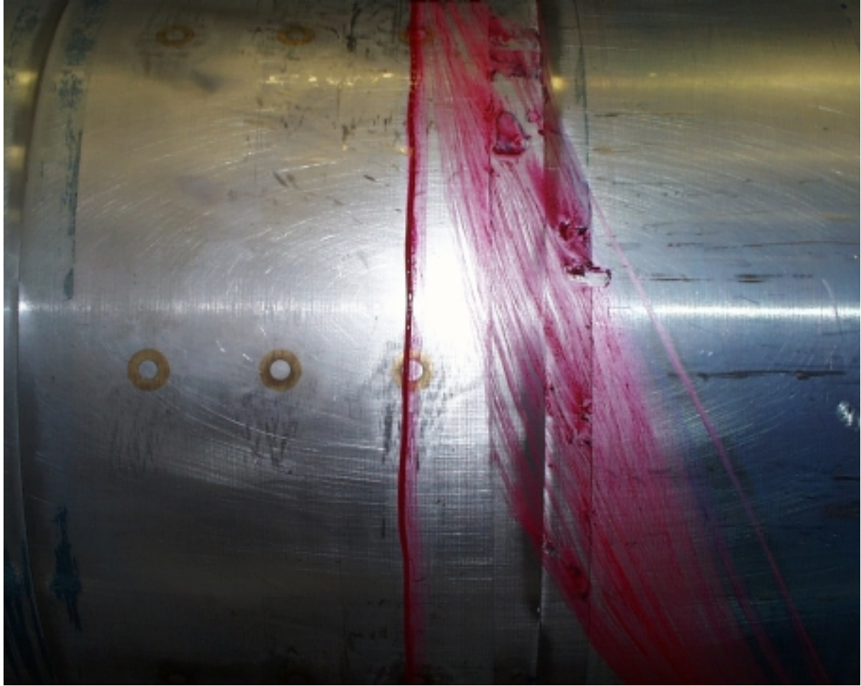
Abbildung 10.11 Teilanstrich, Blick auf die Nabe bei ausgebauten Gittern. Ablöselinie der Nabengrenzschicht vor den Schaufelvorderkanten (Position des Verdichtergitters links der Ablöselinie)
