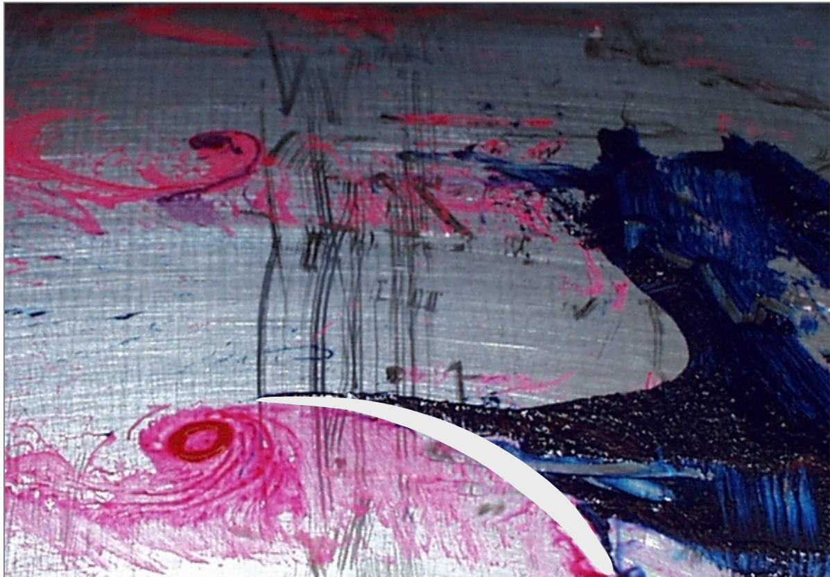
Abbildung 10.3 Anstrich der Nabe bei ausgebautem Verdichtergitter, Strömung von rechts, exemplarisch ist unten im Bild die Position eines Verdichterprofils eingefügt
