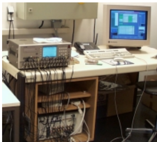
Abbildung 9.4 HP Workstation mit PAK und TEAC Datenrekorder
