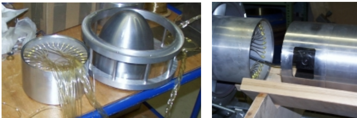
Abbildung 6.-2 PMMA-Einsatz und Nabenelement für Messungen des statischen Drucks (links), in die Nabe eingebaute Miniaturkamera (rechts)
