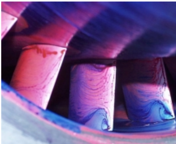
Abbildung 10.15 Blick in das Verdichtergitter (links), Vorderkantenablösungen; Blick in die Schaufelpassage bei ausgebauter Nabe (rechts), Passagenwirbel
