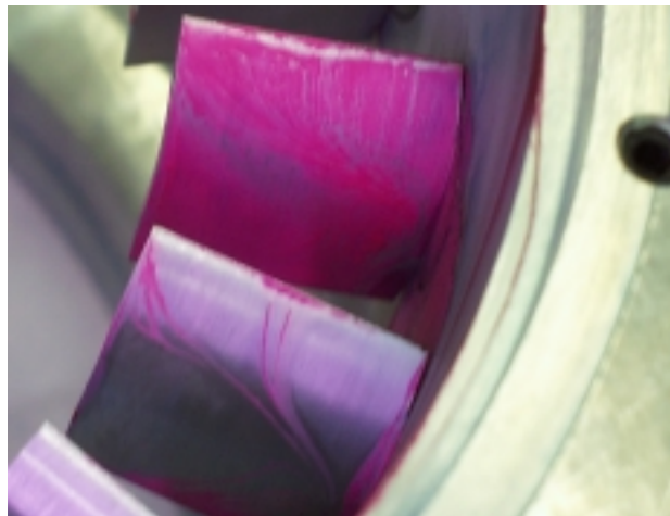
Abbildung 10.9 Teilanstrichbild der Schaufelsaugseite
