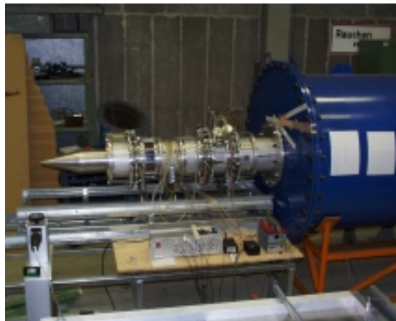
Abbildung 5.1 Ringgittermodell mit Beruhigungskammer und Meßtechnik
