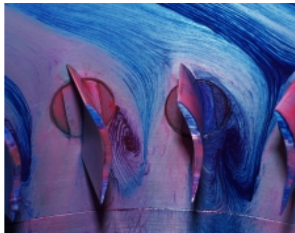
Abbildung 10.15 Blick in das Verdichtergitter (links), Vorderkantenablösungen; Blick in die Schaufelpassage bei ausgebauter Nabe (rechts), Passagenwirbel
