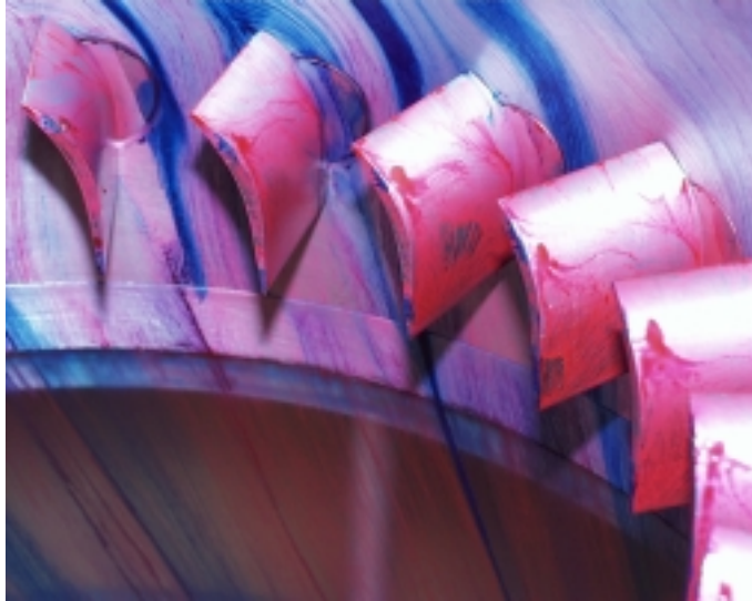
Abbildung 10.6 Schaufelzugseiten und Gehäuse bei ausgebautem Nabenkörper
