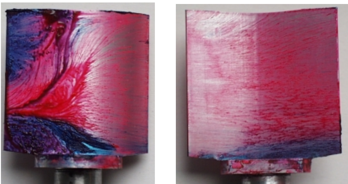
Abbildung 10.1 Saugseite der Verdichterschaufel für einen Anströmwinkel von 51^\circ (links) und Druckseite der Schaufel (rechts)
