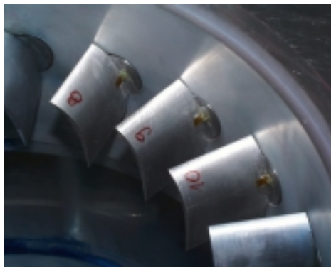
Abbildung 7.6 Mit DMS instrumentierte Verdichterschaufeln (DMS-Halbbrücken, Sensoren auf Schaufelober- und unterseite)
