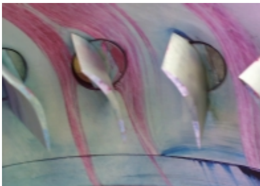
Abbildung 10.10 Teilanstriche, Blick ins Gehäuse; links: vom Vordrallgitter ausgehend mitgerissene Farbe, rechts: Teilanstrich des Verdichterschaufelkanals
