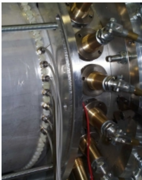
Abbildung 7.7 Im Gehäuse eingebaute piezoresistive Differenzdruckaufnehmer
