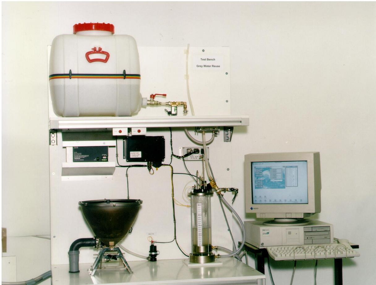
Abbildung 6: Grauwasseraufbereitungsteststand 1
