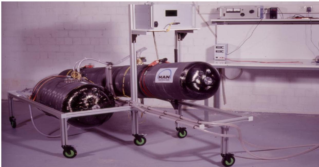
**Abbildung 17:** Sensor-Teststand; Wassertank A330/340
