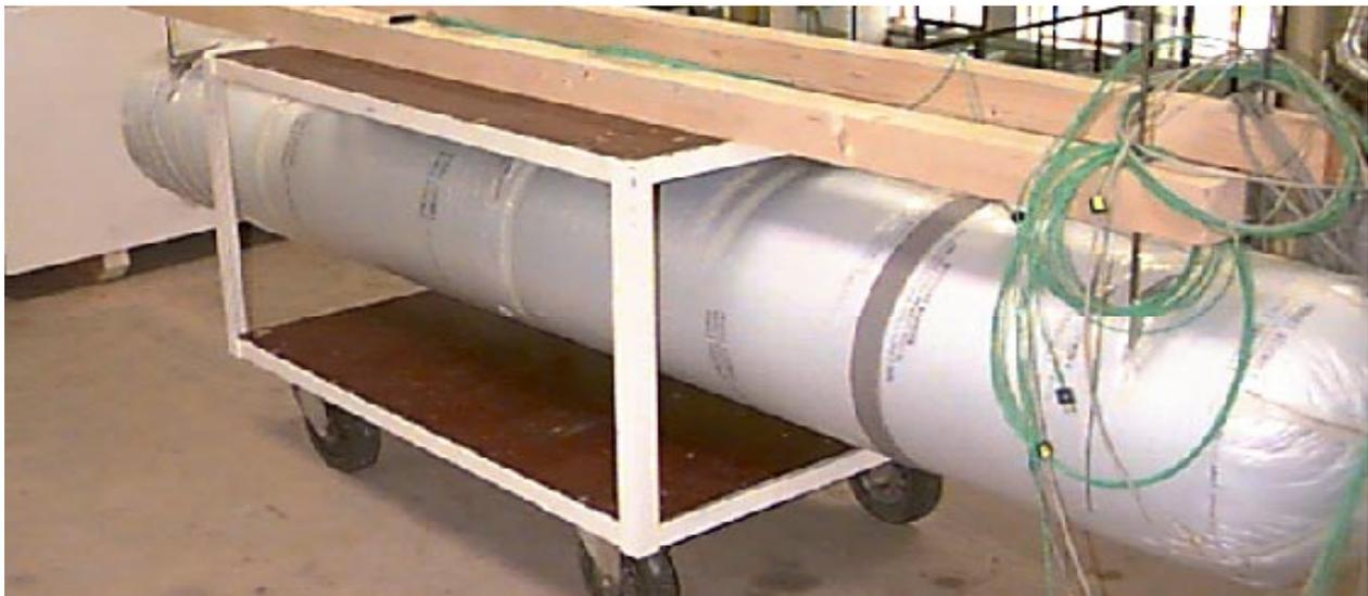
**Abbildung 18:** Trinkwassertank A330/340 mit integrierter Heizung und neuer Isolation
