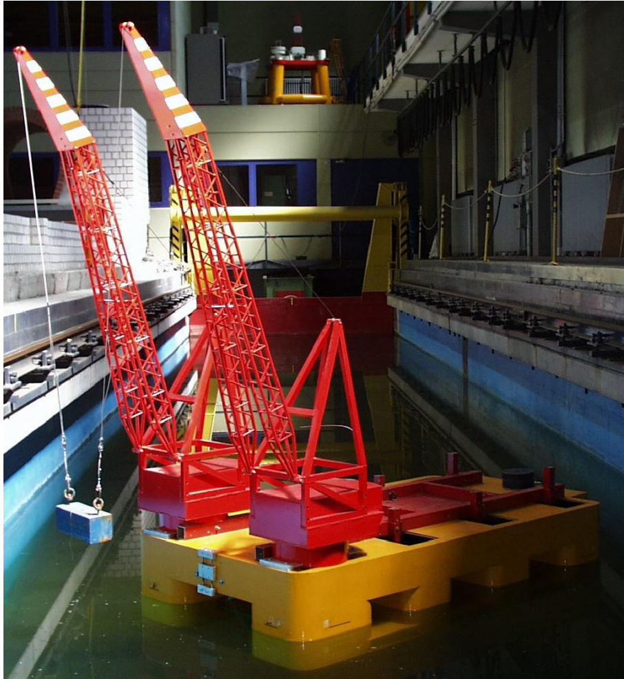
Abb. 27: Kranhalbtaucher THIALF im Wellenkanal
