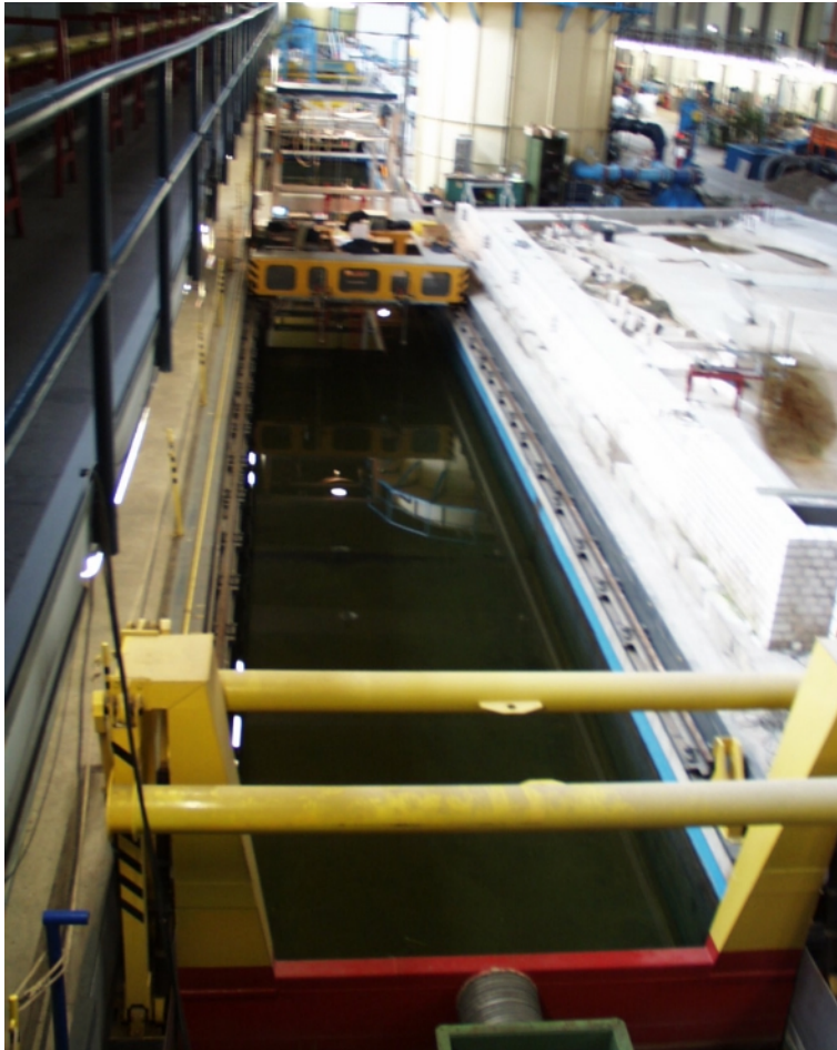
Abb. 9: Wellenkanal der TU Berlin
