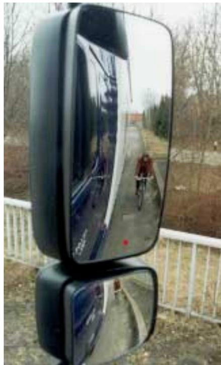
Bild 14 Farbige LED im LKW Außenspiegel [MAN]
