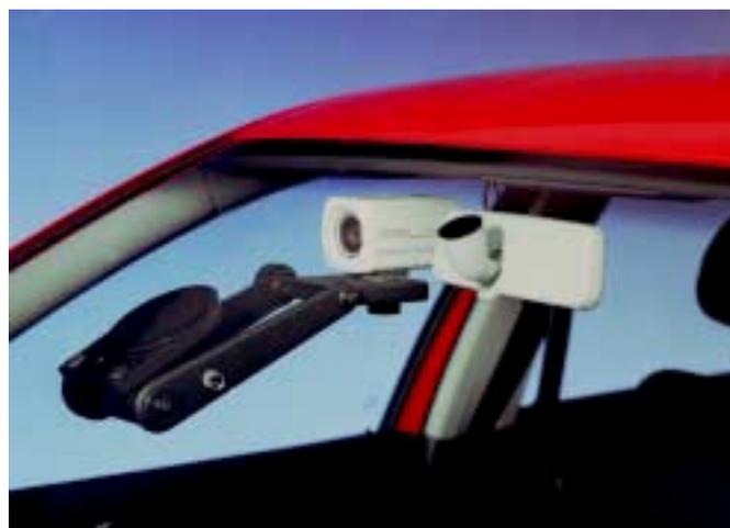
Bild 26 Videokamera in der Windschutzscheibe [VW]
