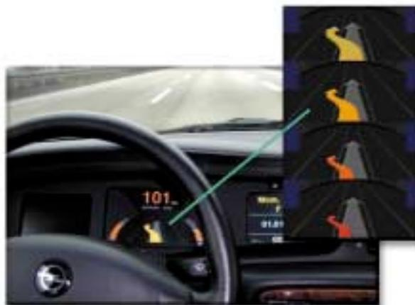
Bild 13 Spurwechselfeile im frei programmierbaren Kombi-Display [Opel]
