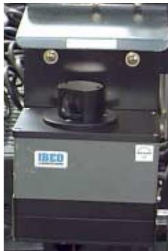
Bild 20 Laserscanner der ersten Generation [MAN]
