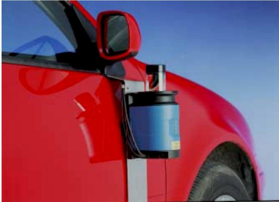
Bild 21 Laserscanner der zweiten Generation [VW]
