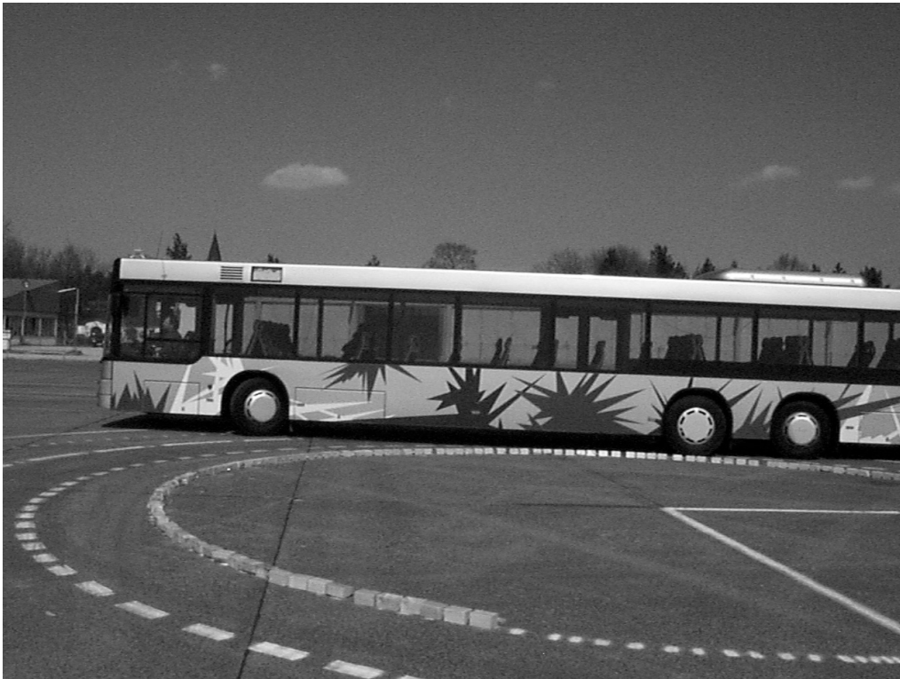
Abbildung 45: Markierungen auf dem Versuchsgelände mit Farbe und Holzklötzen
