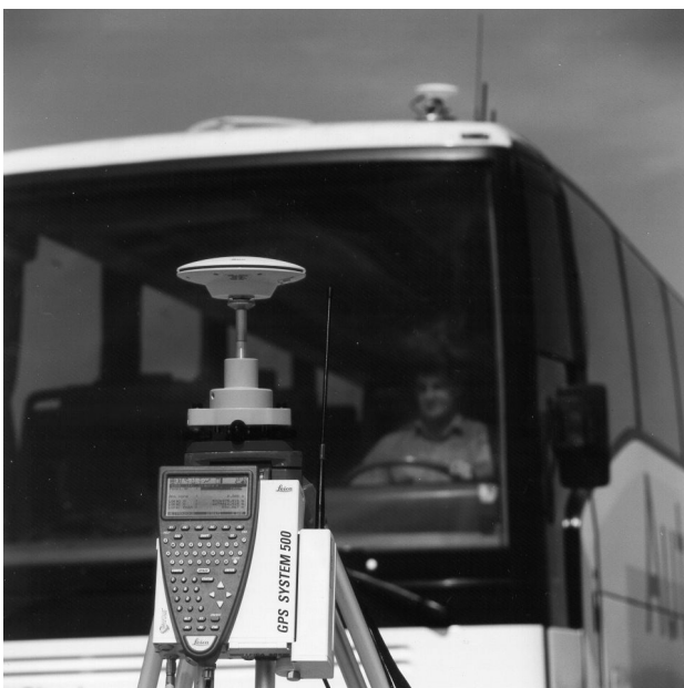
Abbildung 26: GPS-Empfänger auf dem Dach eines Versuchsfahrzeuges mit statischem Referenzempfänger (im Vordergrund) [Foto: HOERPEL, UniBwM]
