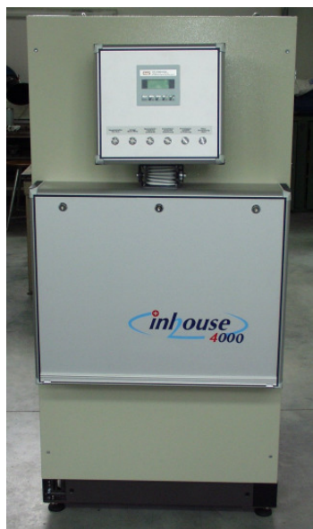
Abb. 7.1: Anlage Typ Inhouse 4000, rechts: Inbetriebnahme 06/2005, im Vordergrund IR - Gasanalysegerätekombination in Verbindung mit Gastrocknung (online Analyse der Prozessgaskomponenten CO in Vol% bzw. ppm, CO 2 in Vol%, H 2 in Vol%, CH 4 in Vol%) mit online Datenerfassung
