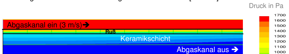
Abbildung 47: Druckverteilung entlang eines Kanals
