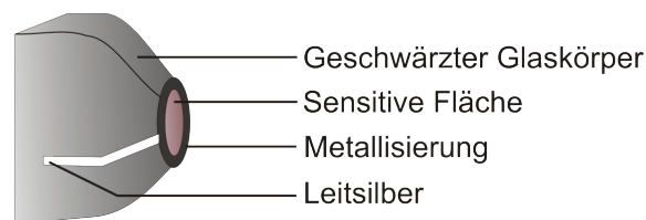
Abbildung 3.10: Schematische Darstellung des in [Law02] entwickelten Messkopfes.
