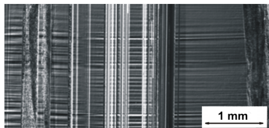
Abbildung 4.20: Mikroschwankungen der Phasengrenzform, Aufnahme im DIC-Modus.
