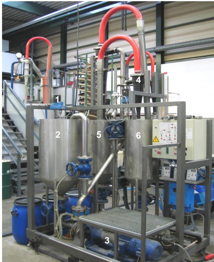
**Abbildung 27:** Hydrozyklonversuchsanlage im Institut für Aufbereitung / TUC
