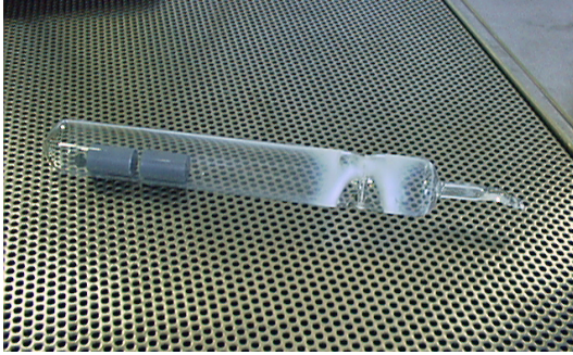
Abb. 4.1: Bild einer typischen Anordnung zur thermischen Nachbehandlung der Probenkörper gekennzeichnet durch eine SiO 2 -Glühampulle, zwei SI-GaAs-Probenkörper sowie durch die As-Zuwaage.
