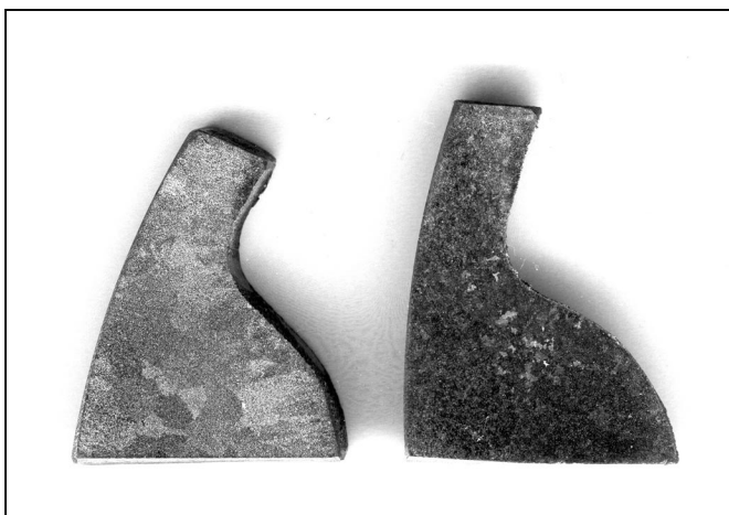
Bild 61: Gefüge Schleifring; \text{CuSn5Zn5Pb5} ; rechts vibriert mit 30 Hz; 1,5g
