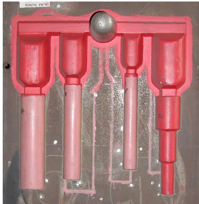
Bild 49: Modellplatte zur Herstellung von Rundstäben verschiedener Wanddicken (Ø25; 35; 50 mm)
