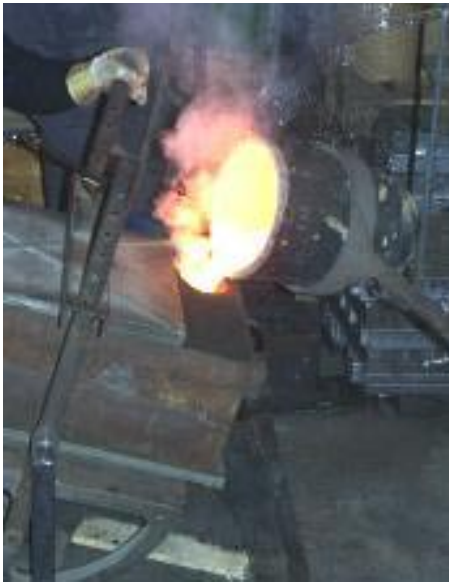
Bild 17: Kippguss bei Gießbeginn
