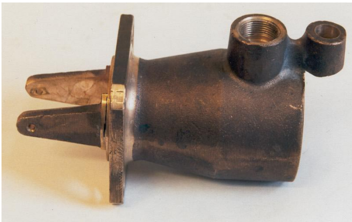
Bild 56 : Armaturenteil aus Rotguss CuSn5Zn5Pb5
