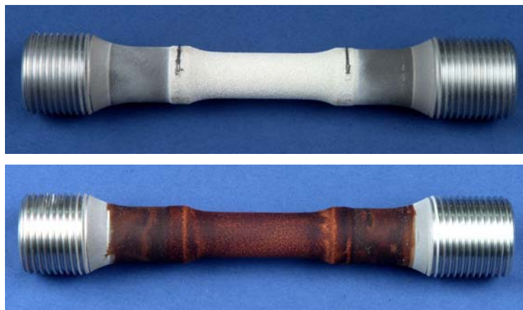
Abbildung 3.62: APS-TBC-beschichtete Proben für TMF-Versuche. Oben ist eine Probe mit CrNi-Drähten für die Dehnungsmessung. Unten ist eine Emulsion mit Eisenoxid aufgetragen.
