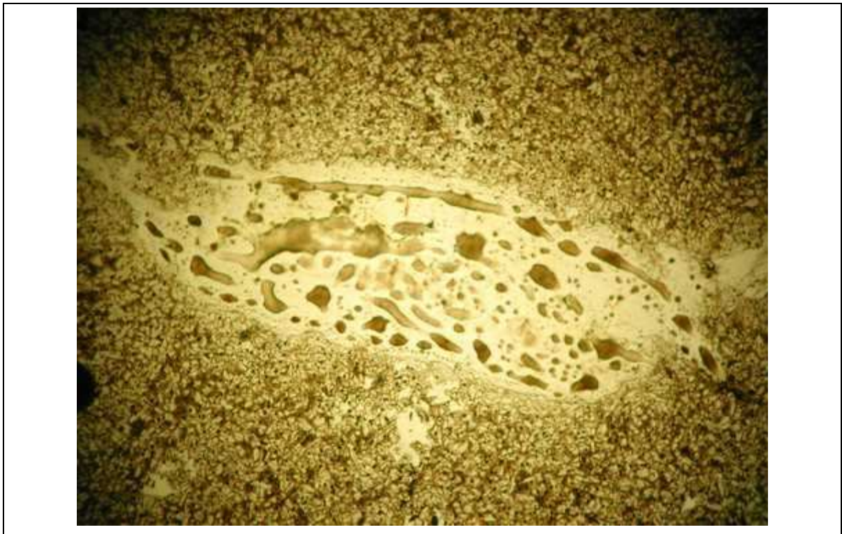
Abbildung A23: Schmelzbildung beim Auflösen eines Restkristalls, (Vergrößerung 10 fach), Schmelzbasalt Probe 1506-4
