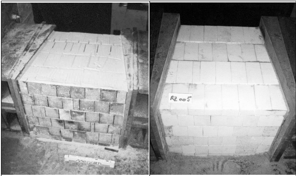
Abbildung 5-5: Modellwiderlager aus Betonsteinen (RZ 011)
