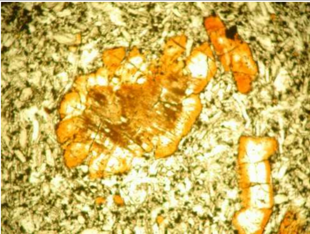
Abbildung A4: Alterationshöfe aus Amphibol um Klimopyroxen (Detail 3 / Probe 1, Vergrößerung: 10-fach)
