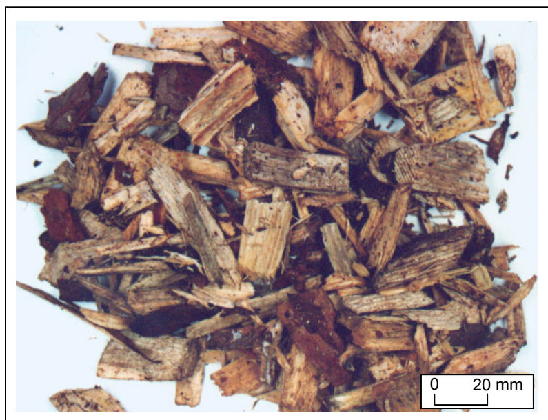
Abb. 5.2: Holzhackschnitzel im Anlieferungszustand
