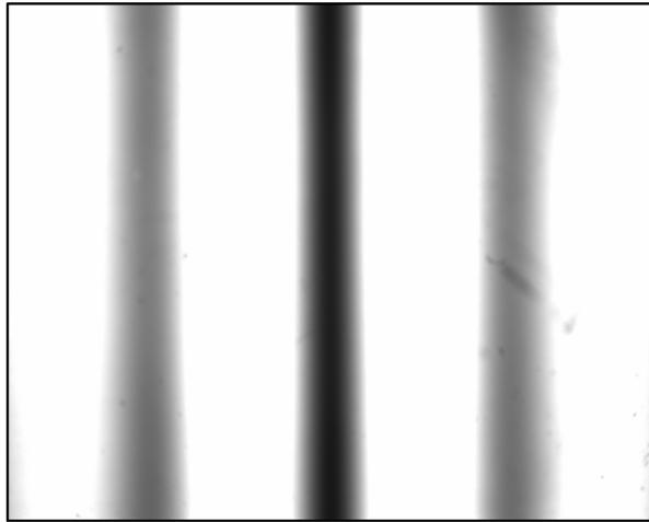
*Bild 11: Wollaston-Prisma im Dunkelfeld gekreuzter Polarisatoren*
