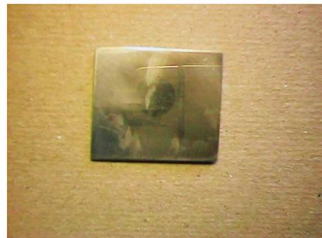
Abbildung 32: NiP (0,5µm) auf Glas (Variante 2) (Draufsicht)
