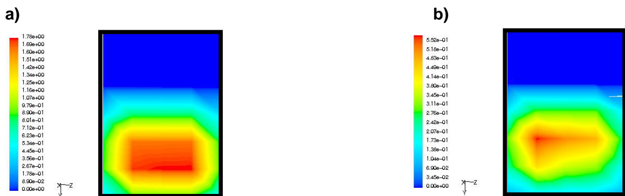
Abbildung 7-1: Das Profil der Austrittsgeschwindigkeit an der Tauchrohraustrittsöffnung
