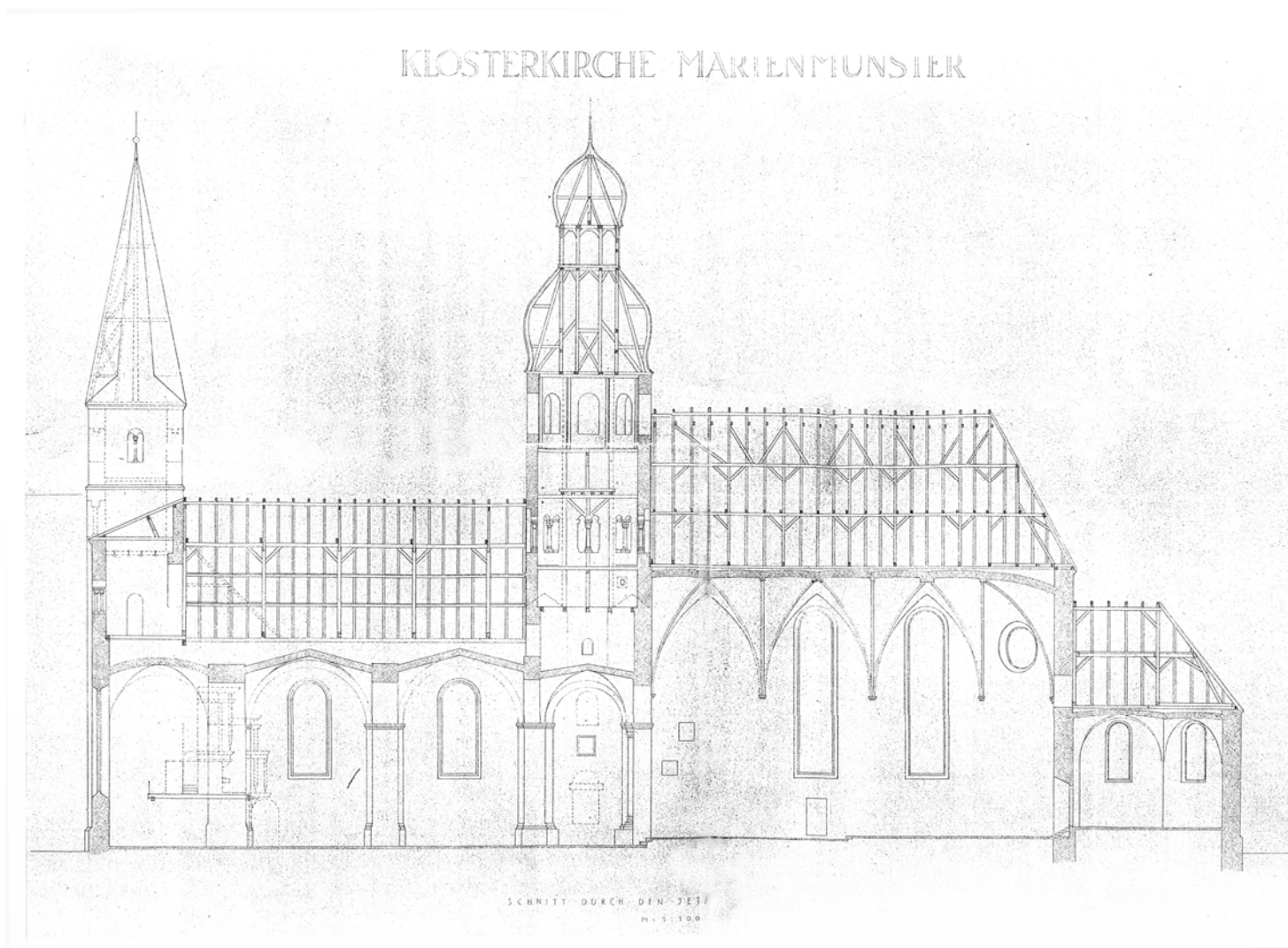
Abbildung 21: Klosterkirche Marienmünster, Schnitt durch den jetzigen Zustand. – OLDEMEIER 1942, Heft II, Blatt 2.
