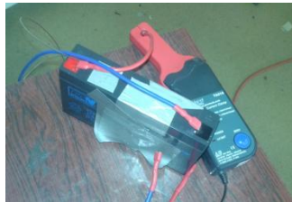
Rys. 3. Wykorzystanie cęg prądowych podczas ładowania ogniwa
