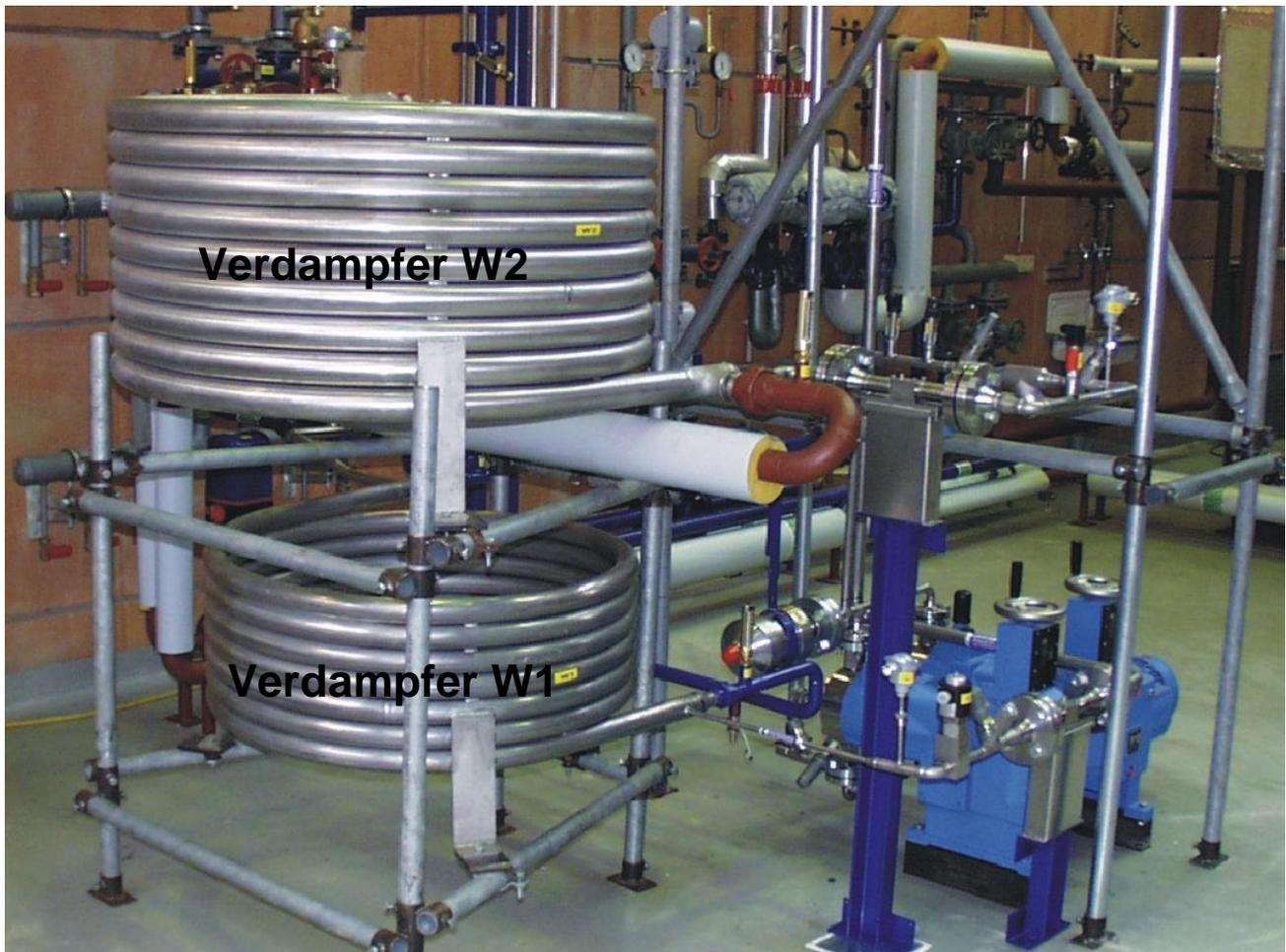
Bild 23: Foto der Anlage mit den Verdampfern und der Hochdruckpumpe
