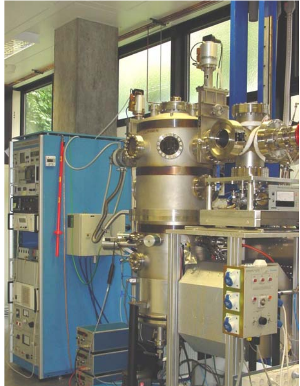
Abbildung 5: (a) Schematische Darstellung des Depositionsreaktors zur ionenassistierten Deposition. Silicium wird mittels eines Elektronenstrahlverdampfers verdampft und in-situ durch Sublimation von Bor bzw. Phosphor dotiert. Eine Ionisationsstufe ionisiert ca. 1 % der hindurchtretenden Si-Atome durch Elektronenbeschuss aus einem glühenden W-Draht. Eine Spannung von V_{acc} = 20 \text{ V} beschleunigt die Si-Ionen zum Substrat hin, das mittels Halogenlampen geheizt wird. (b) Photo der IAD-Anlage. Im Vordergrund sind Schleusenkammer und Ionengetterpumpe zu sehen, dahinter die Depositionskammer, links befindet sich der Elektronenschrank.
