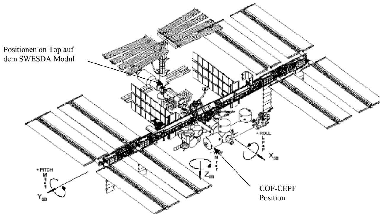
Der Scan des Himmels erfolgt prinzipiell aufgrund der Bewegung der ISS im Orbit; um jedoch im Laufe der Mission den gesamten Himmel zu sehen, muß das Teleskop um ca.  $\pm 38^\circ$  um die Z-Achse der ISS geschwenkt werden
