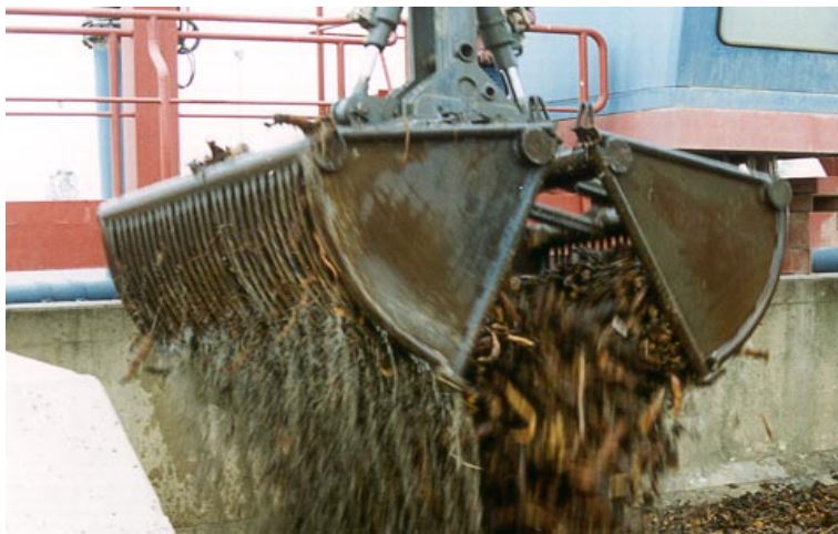
Abbildung 53: Waschvorgang mit dem Kran
