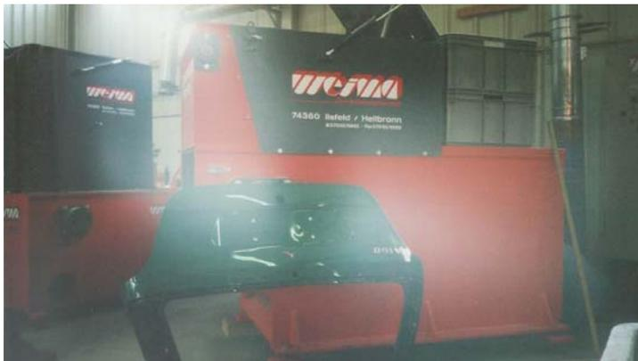
Abbildung 8 WLK Serie mit Heckklappe der Mercedes A-Klasse vor der Zerkleinerung
