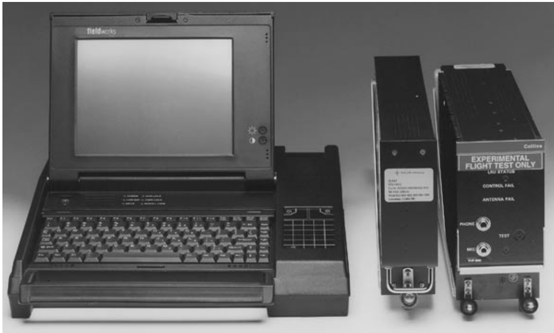
Abbildung 9.4 Datenrecorder, Navigationsempfänger GLNU und Datenlink-Empfänger VHF 900 (von links nach rechts)
