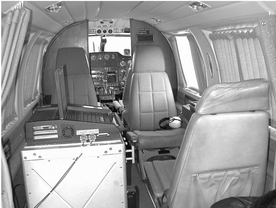
Abbildung 9.6 Geräteeinrüstung für Flugversuche (Flugzeug PA 31 der NFS)
