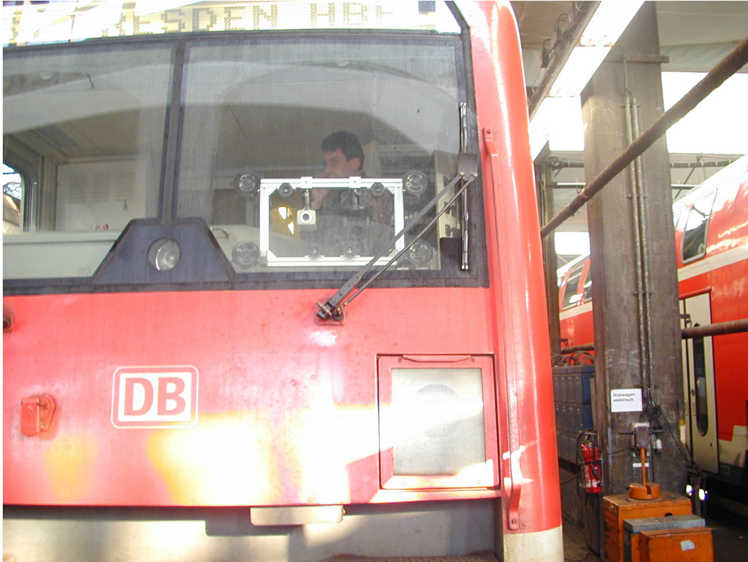
Abbildung 34 Kameraträger in einem S-Bahn Steuerwagen
