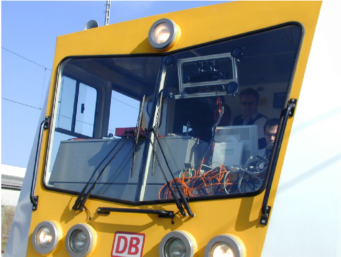
Abbildung 33 Einbau der Hinderniserkennung im Testfahrzeug
