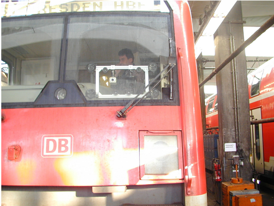
Abbildung 16 S-Bahnsteuerwagen mit Kameraträger hinter der Scheibe
