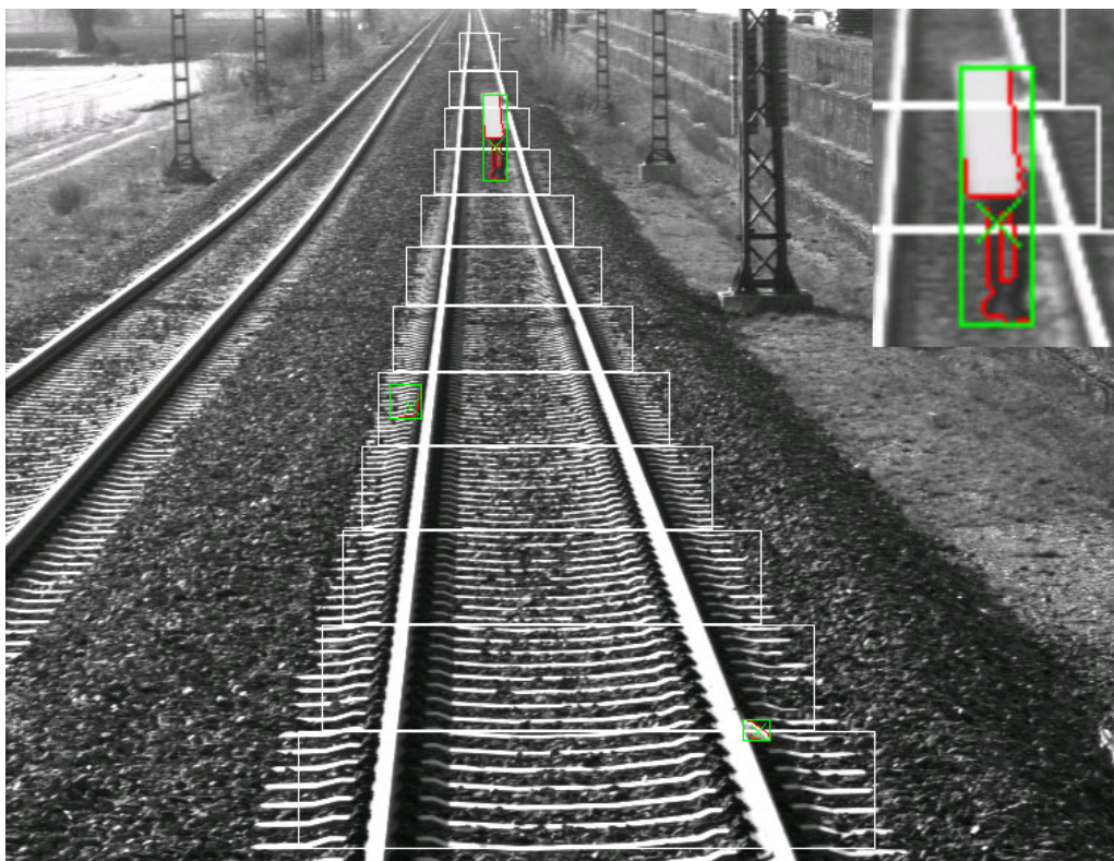
Abbildung 17 Durch Analyse der Kantenelemente detektiertes entferntes Objekt.
