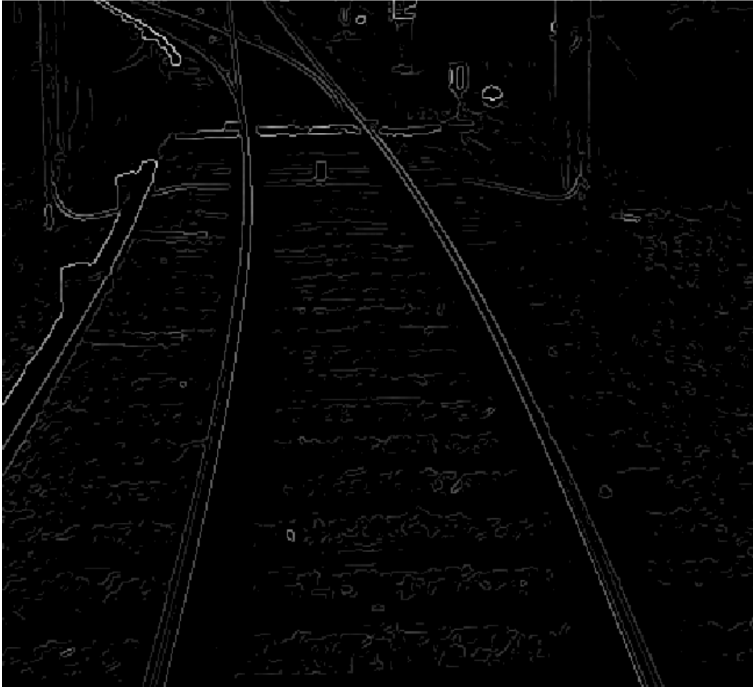
Abbildung 10 Durch den NAG-Operator berechnetes Kantenbild
