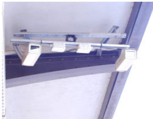
Abbildung: Mechanische Halterung für ein Kamera- paar
