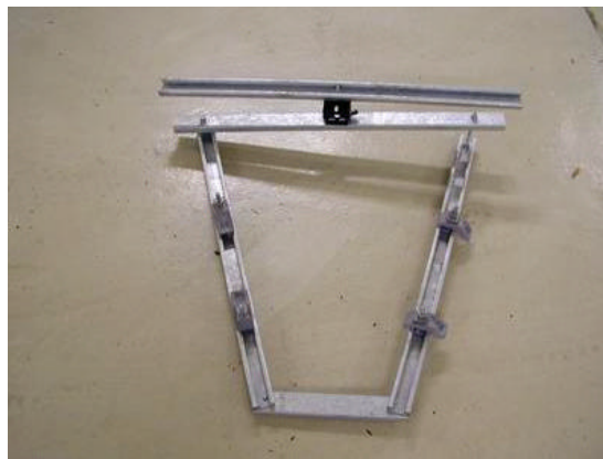
Abbildung: Demontierte Halterung für ein Kamerapaar
