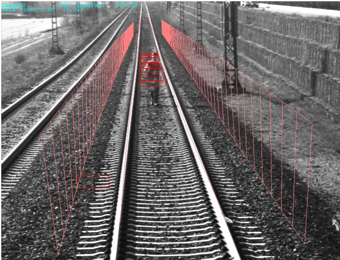
Abbildung 19 Detektierte Objekte der Varianzanalyse. Es ist zusätzlich der Gleisverlauf und das zu überwachende Lichtraumprofil dargestellt.
