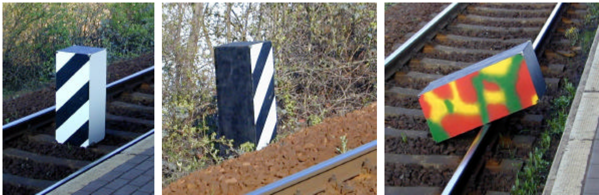
Abbildung: Prüfkörper nach [LH AF3] mit unterschiedlichen Kontraststufen
