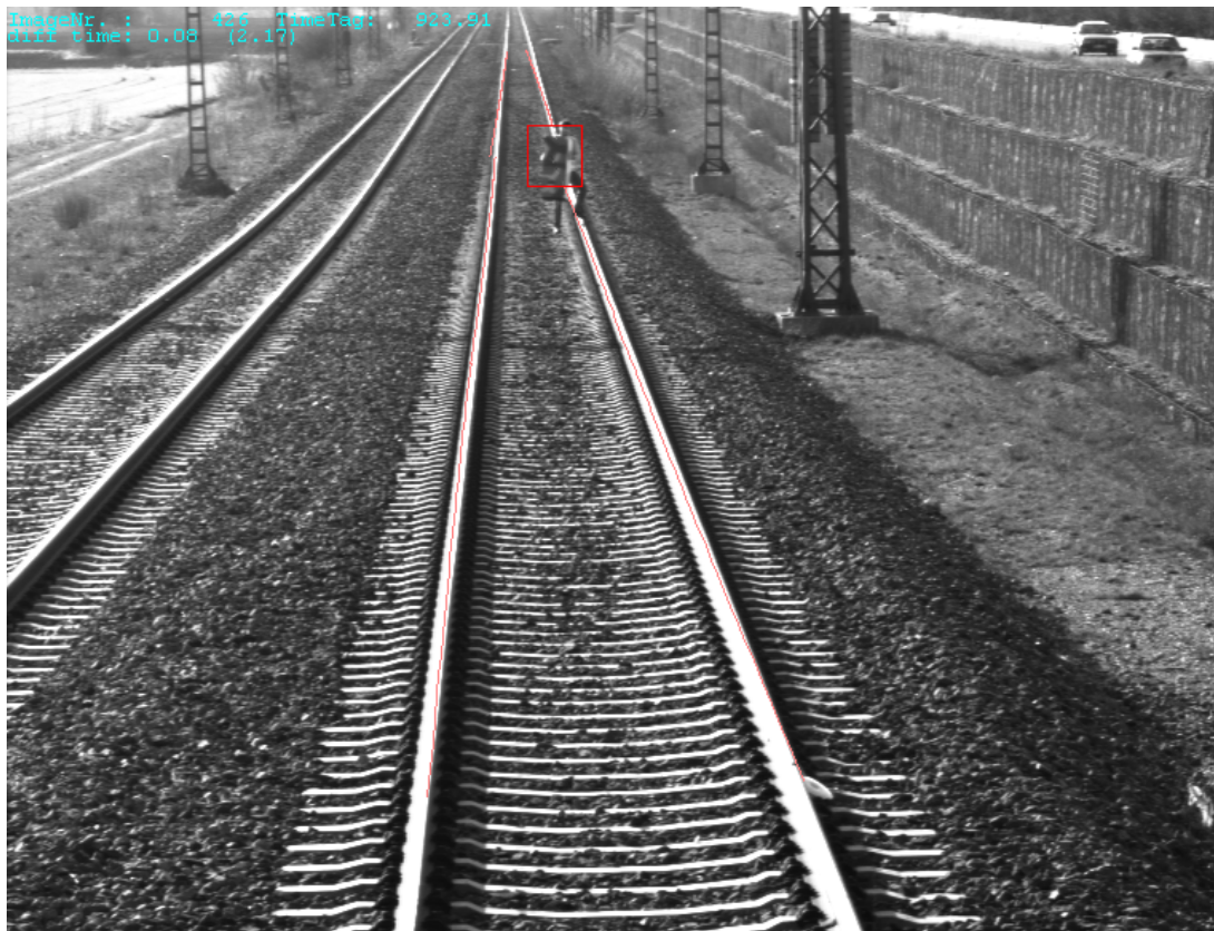
Abbildung 23 Auf Grund von Bewegungen im Bild detektiertes Objekt
