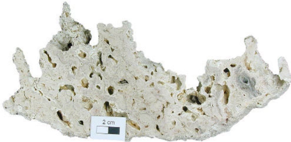
Abb. 3: Aragonitisches Chemoherm-Karbonat mit hoher Porosität.
