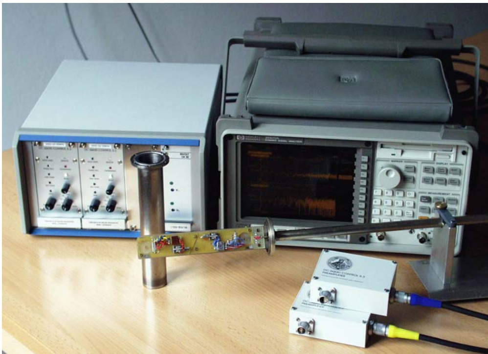
Abb. 7.3: Zweikanal-Rauschmessplatz, bestehend aus 2-Kanal-SQUID-Elektronik mit rauscharmen Vorverstärkern, Spektrumanalysator und Messkopf.
