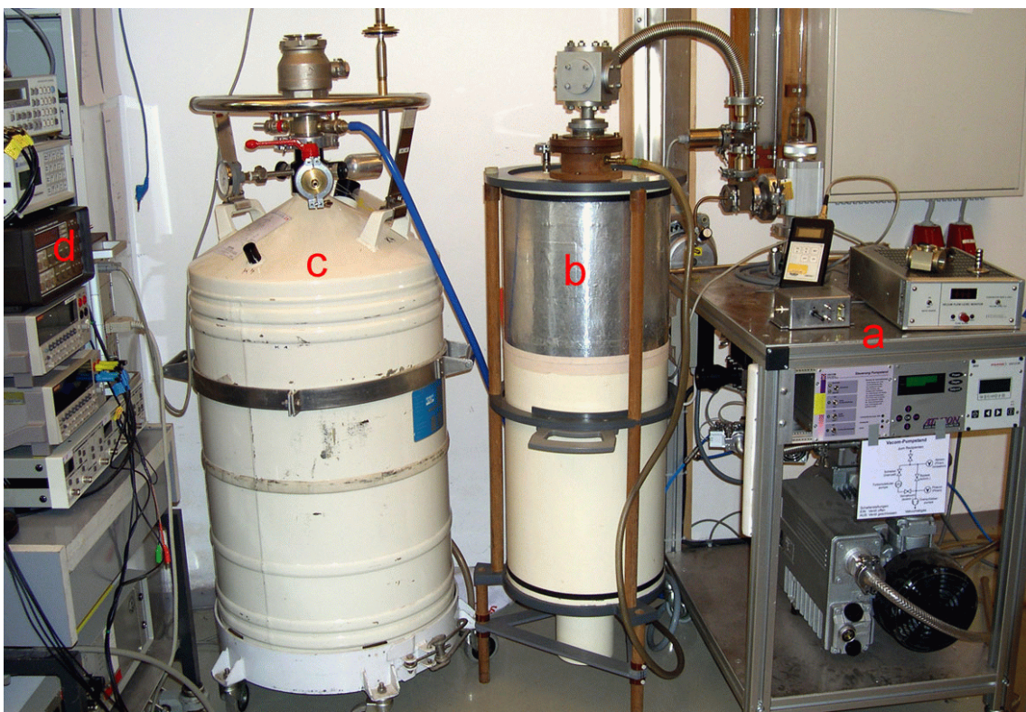
Abb. 1.1: Meßplatz zum Test von Komponenten bei kryogenen Temperaturen und unter Vakuumbedingungen (a - He-dichter Pumpstand, b - Kryostat, c - He-Weithalskanne, d - elektronische Meßtechnik).
