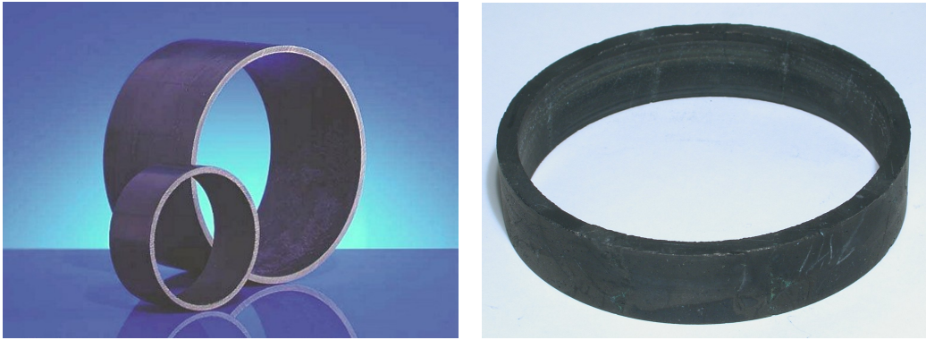
Abb. 1.2: HTSL-Ringe – Bi-2212 (links) und Y-123 (rechts)
