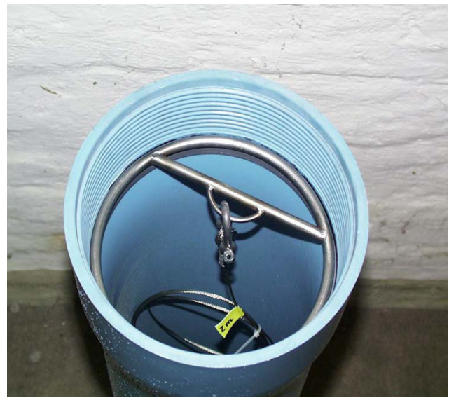
Abbildung 4: CTD-Speichersonde am Drahtseil und Ring zum Einhängen in den Brunnen Abbildung 5: Einhängen der CTD-Speichersonde in den Brunnen
