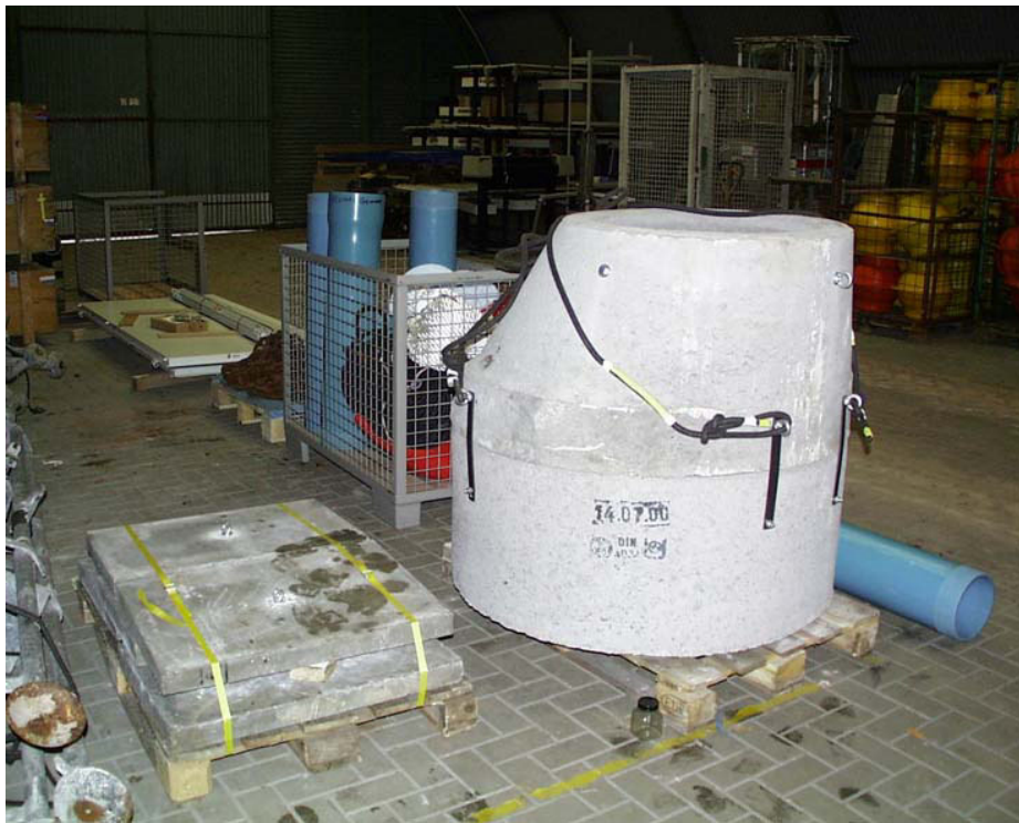
Abbildung 3: Betonring als Schutzmantel des Brunnens
