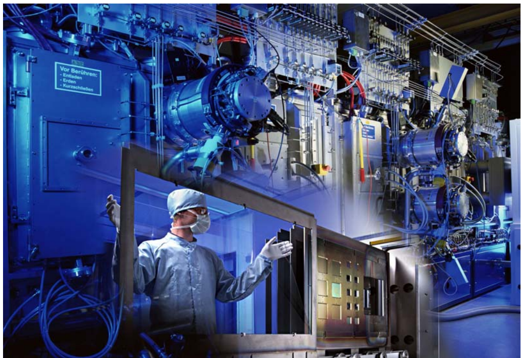
Abb. 1: Die vertikale In-Line Sputteranlage Leybold A700V des Fraunhofer IST. Im Vordergrund ist der Ein- und Ausgabebereich im Reinraum zu erkennen.
