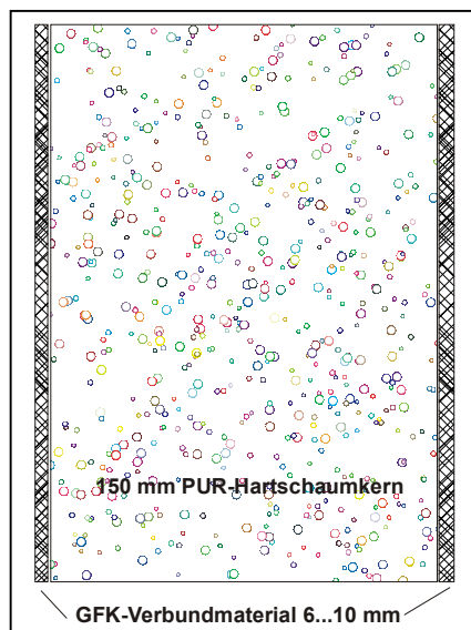
Abbildung 9: Prinzipieller Aufbau der Speicherwand mit integrierter Dämmung
