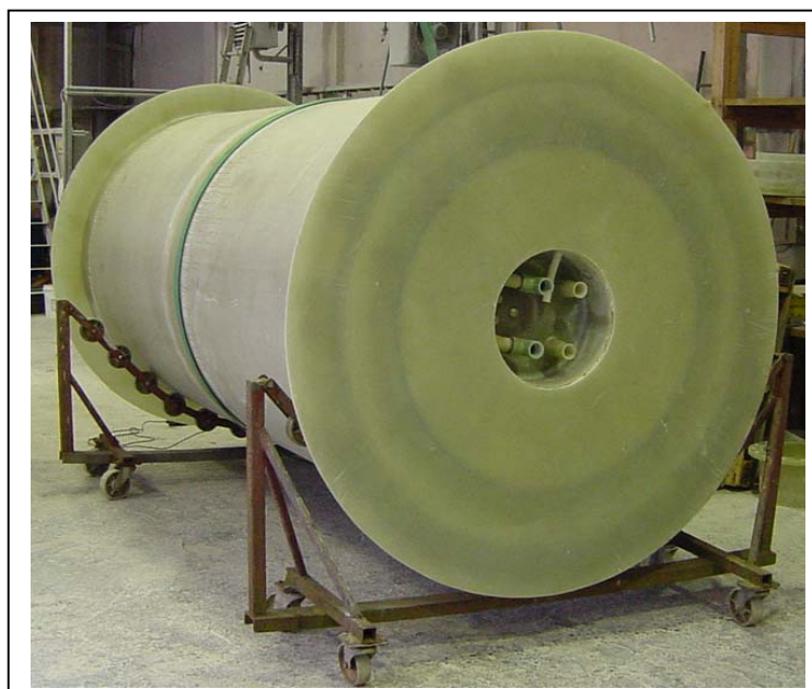
Abbildung 50: Bodengestaltung des 5 m 3 GFK – Pufferspeichers
