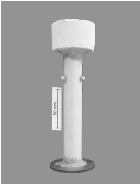
Abbildung 1: Formenaufbau des Gießbarkeitstest bei WTM (alt).
