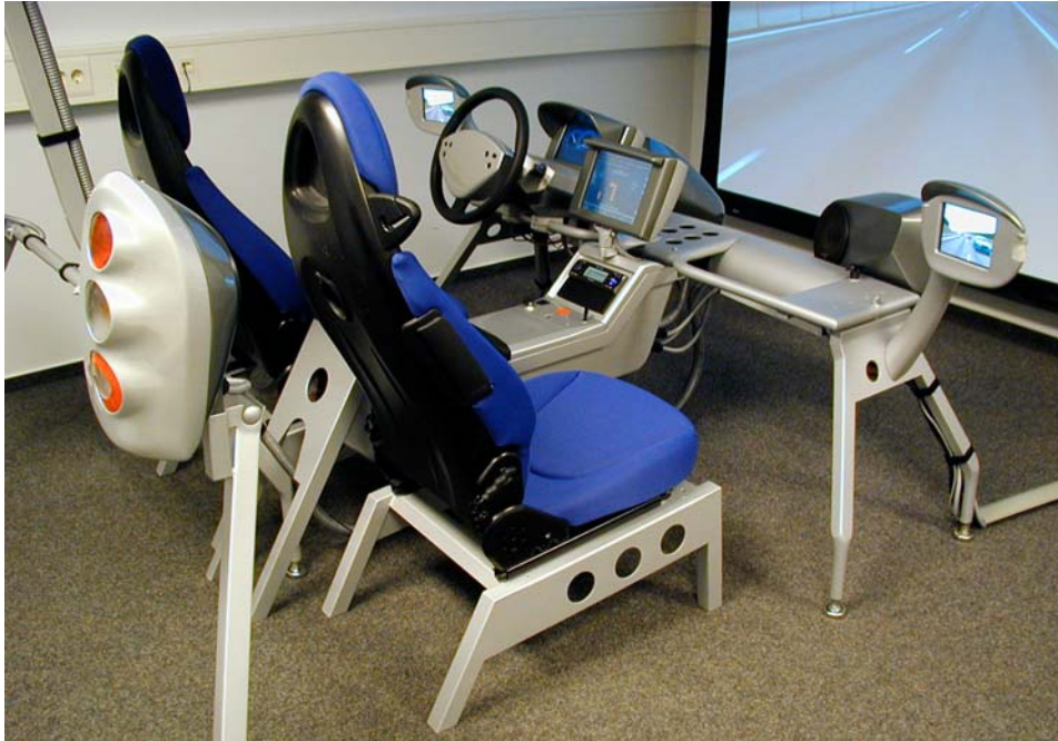
Abbildung 25: Ansicht der gesamten Sitzkiste mit Leinwand für Fahrsimulation
