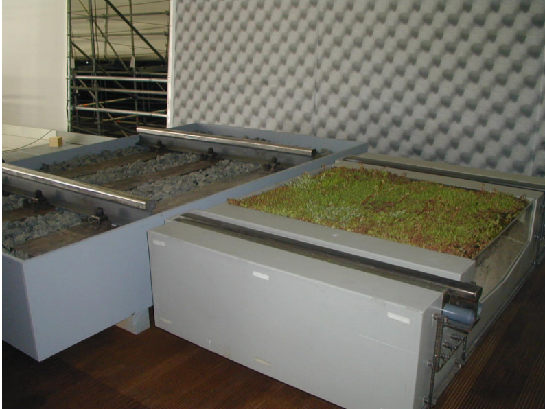
Abbildung C-3: Oberbaumodelle im Maßstab 1:1 – Frontalansicht. links: Schotteroberbau, rechts: Feste Fahrbahn INFUNDO mit technischer Begrünung
