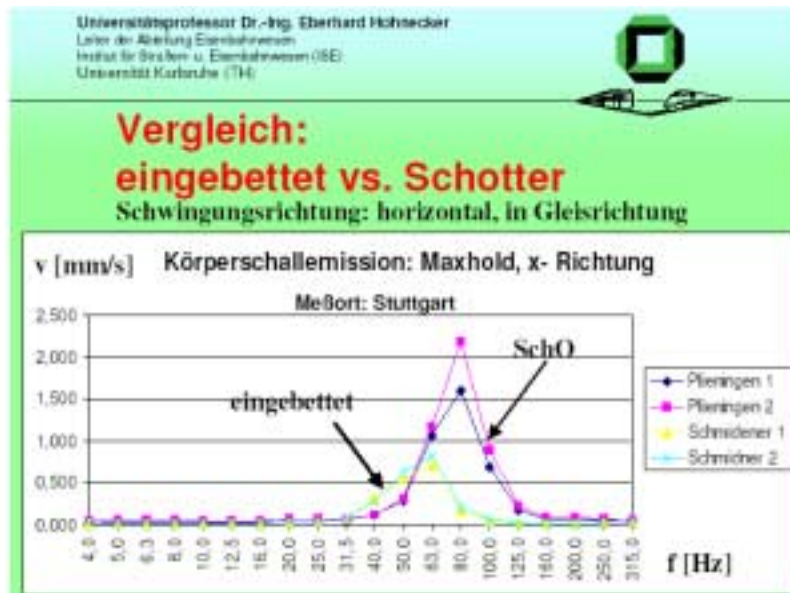
Abbildung A-12: Vergleich der Messungen Schotteroberbau (Plieningen) und Feste Fahrbahn (INFUNDO, Stuttgart Schmidener Straße). oben: Luftschallpegel Schotter (Plieningen, blaue Kurve) gegenüber Feste Fahrbahn (rosa Kurve). unten: Körperschallpegel Schotter (Plieningen, schwarze und rosa Kurve) gegenüber Feste Fahrbahn (grüne und gelbe Kurve)
