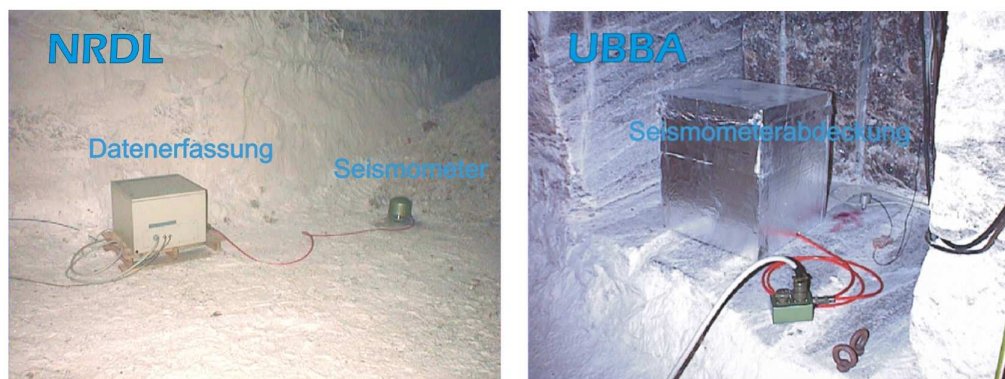
Abbildung 6.7: Seismometer-Standorte (unter Tage) an den Stationen NRDL (links) und UBBA (rechts). Die Seismometerabdeckung zur Verringerung von Unruhe durch Temperaturschwankungen und Konvektion ist an der Station NRDL entfernt.
