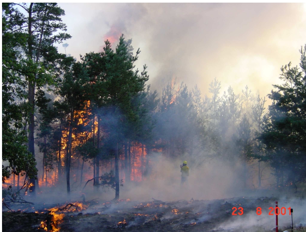
Abbildung 5.2: Ansicht des ersten DFNK-Waldbrandexperiments in der Lausitz (August 2001). Hier baut sich ein Bodenfeuer in einem jungen Kiefernbestand als Kronenfeuer auf.
