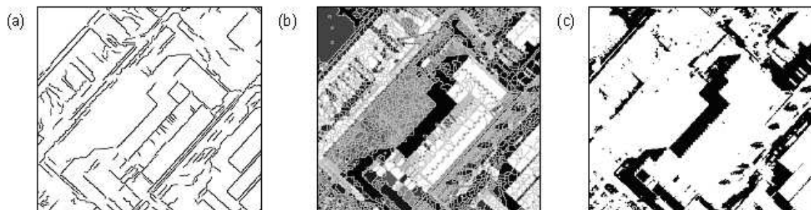
Abbildung 2.20: Mögliche Prozessierungsschritte im zweiten Teil des Ansatzes: (a) Extraktion gerader Kanten, (b) Segmentierung des Bildes in homogene Regionen, (c) Extraktion von Schatteninformation.
