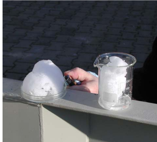
Bild 2.5: Bei Fraunhofer UMSICHT hergestelltes Methanhydrat beim Entzündungsversuch
