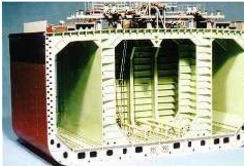
Abb. 4.10 Sektion eines Doppelhüllentankers (Modell)
