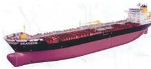
Abb. 4.11 Modell eines Doppelhüllentankers
