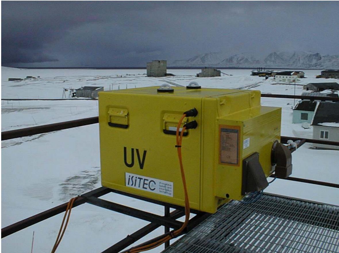
Abb. 4 Das kombinierte UV-A/B Spektralradiometer mit den zwei getrennten Eingangskuppeln für UV-A und UV-B auf dem Dach der NDSC-Station des AWI in Ny-Ålesund auf Spitzbergen
