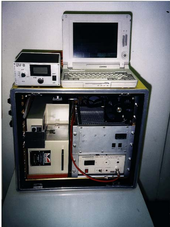
Abb. 1 Innenansicht des UV-B Spektralradiometers: Links der Doppelmonochromator (Bentham DM 150), rechts das Hochspannungsnetzteil und die Elektronik. Der Detektor befindet sich nicht sichtbar hinter dem DM 150.
