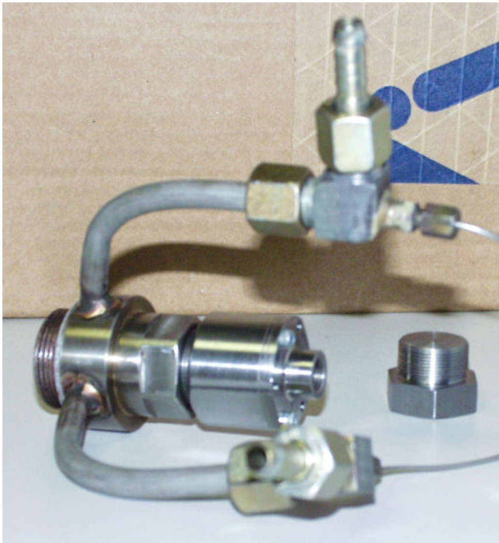
Abbildung 33: Ausführung Einspritzventil für externe Nacheinspritzung
