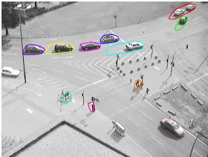
Abb. 38: Objektsegmentierung des Frames #1183 mit starker Änderung der Lichtverhältnisse
