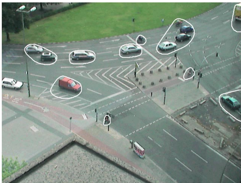
Abb. 43: Approximation durch B-Splines mit 12 Kontrollpunkten (Frame #160)
