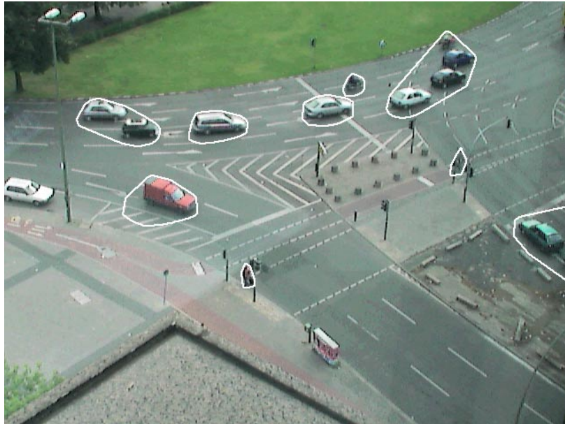
Abb. 40: Konvexe Konturen der segmentierten Objekte des Frames #160
