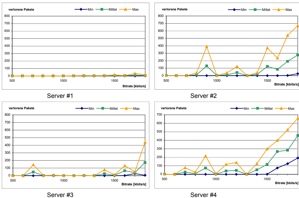
Abb. A.9 : Einzelwerte der Paketverluste bei 4 Servern
