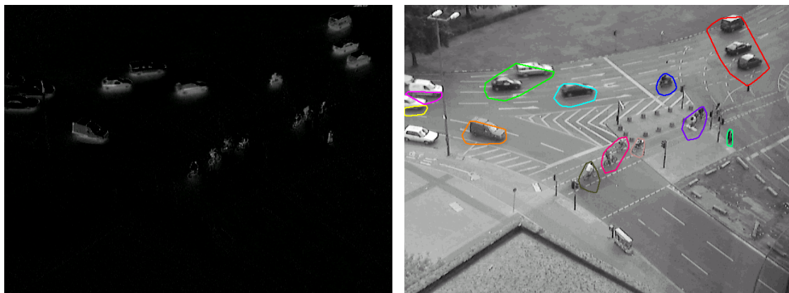
Abb. 6: Differenzbild ( links ), Schwellwertverfahren und Konnektierung ( rechts )
