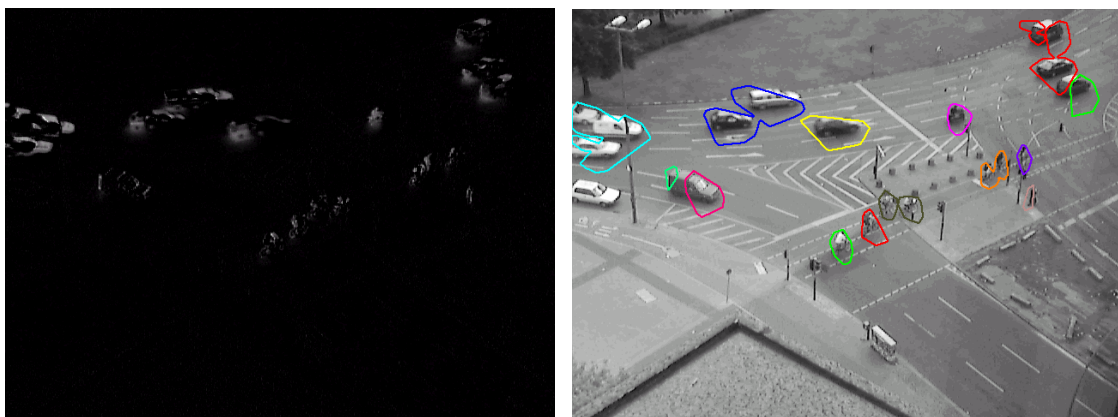
Abb. 4: Differenzbild ( links ), Schwellwertverfahren und Konnektierung ( rechts )
