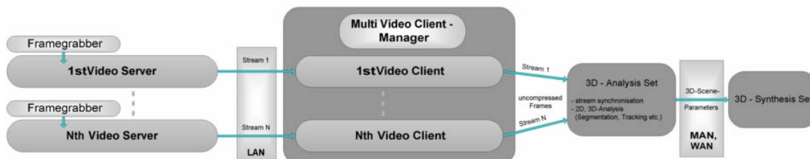
Abb. 14 Erweiterung des Videostreamingsystems zur 3D Rekonstruktion
