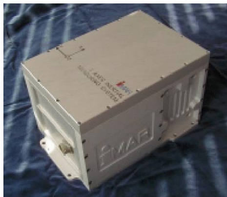
Abbildung 6.1-5: Die im Rahmen UniTaS II neu angeschaffte Trägheitsplattform iMAR SYS124
