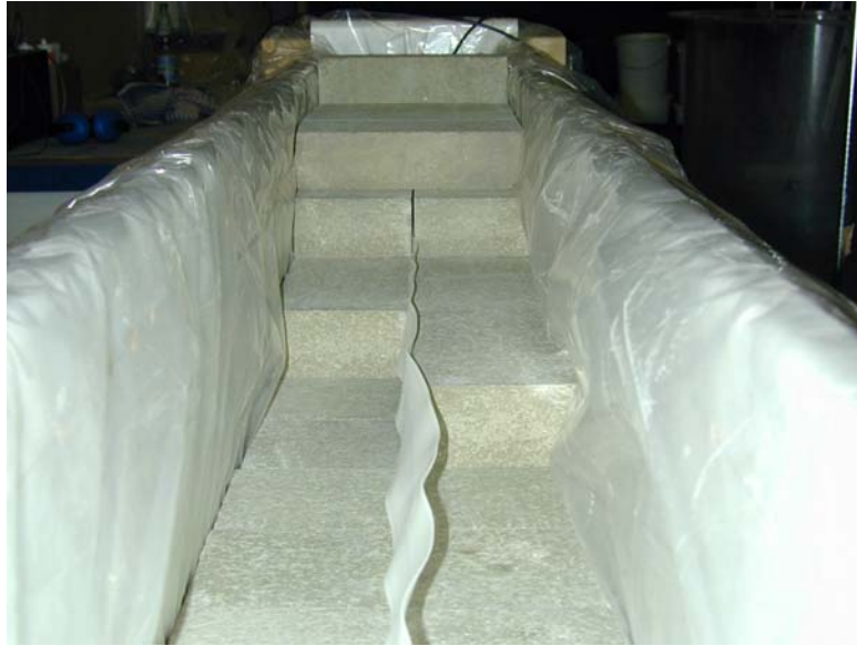
Bild 8.12 Sensorkabel zur Bestimmung der Impulsantwort in Bentonitformsteinen
