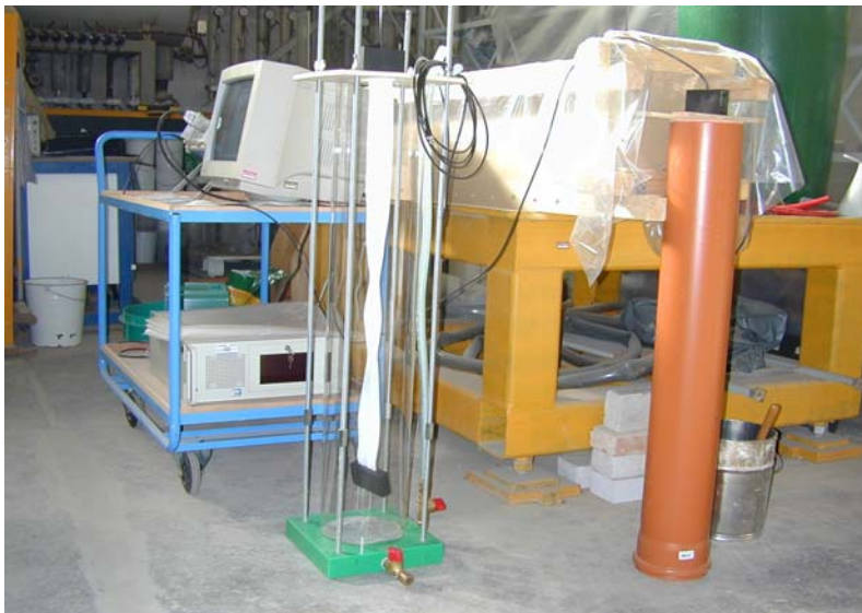
Bild 8.4 Versuchsaufbau zur Befüllung eines Rohres
