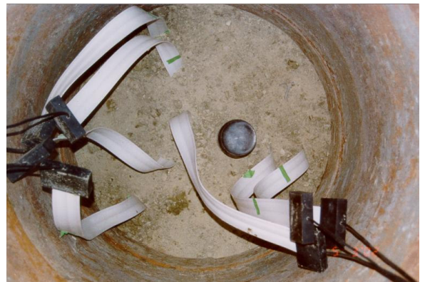
Bild 16 mittlere Bentonitschicht relativ trocken (1,20 m)
