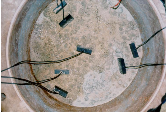
Bild 13 Schotter ausgebaut (-0,45 m) Oberfläche binäres Gemisch
