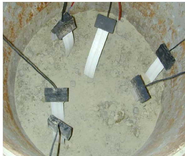
Bild 11.4 Einbau von binärem Gemisch und Bandkabeln in die großkalibrige Permeabilitätsapparatur
