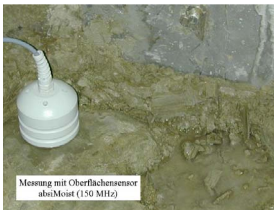
Bild 4.6 Messung an stark durchfeuchteten Stellen (a) und an der Wand (b)
