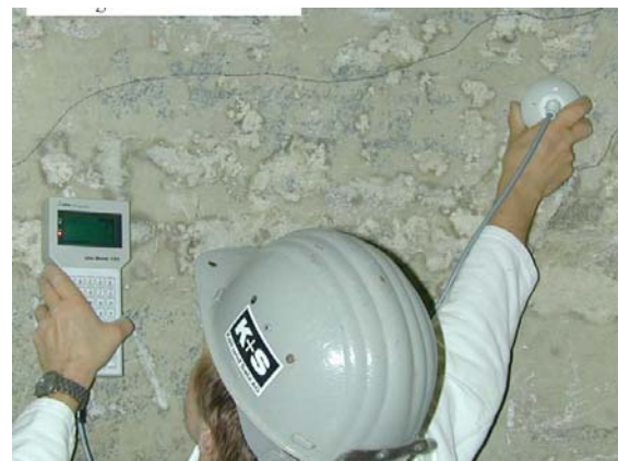
Bild 4.6 Messung an stark durchfeuchteten Stellen (a) und an der Wand (b)
