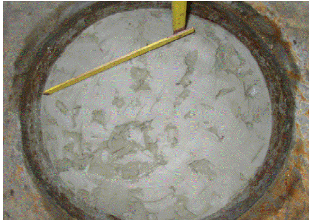
Bild 11.29 Aufgelockerter Bereich des Dichtelementes im Versuch KU 7
