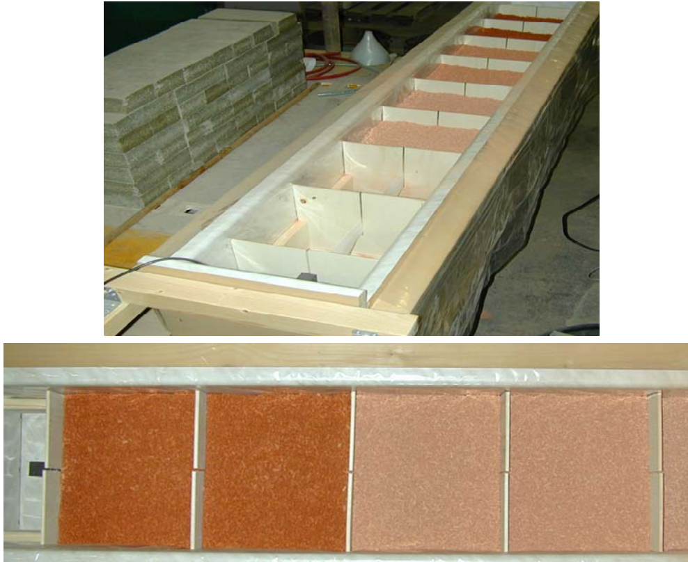
Bild 8.14 Trog mit Kabelsensor und Kammern, die mit Materialien unterschiedlicher Feuchte befüllt werden können
