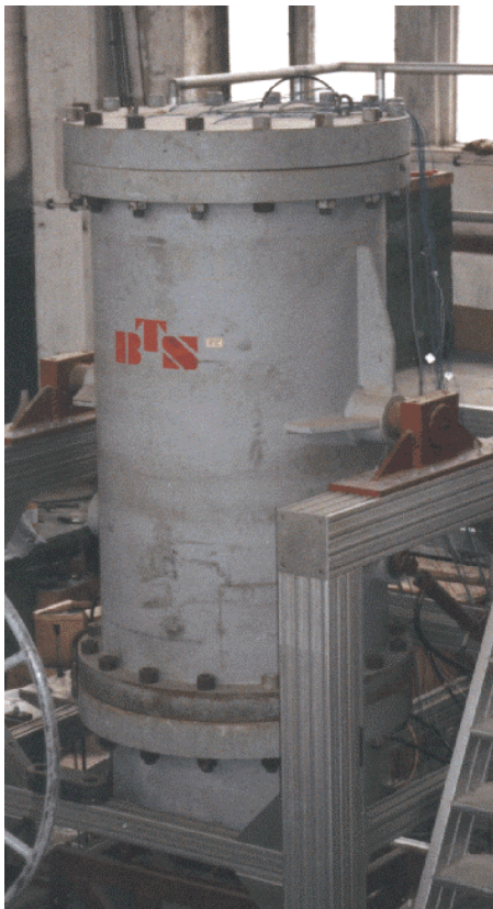
Bild 11.1 Großkalibrige Durchströmungsapparatur (GrokaPerm)
