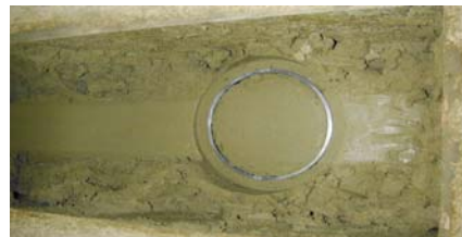
Bild 9.1 a) Messaufbau zur Kalibrierung mit eingebautem Sensor; b) Lage des Kabelsensors im Sand-Bentonit-Gemisch; c) Entnahme von Materialproben unter dem Kabelsensor zur Bestimmung von \epsilon_r' und \tan\delta mit dem Netzwerkanalysator
