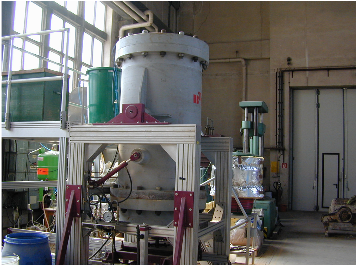
Bild 2 Druckbehälter in der Technikumschule
