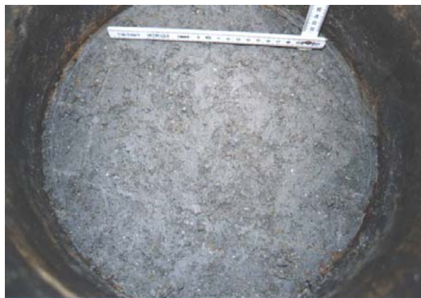
Bild 11.18 Gleichmäßige Durchfeuchtung der MX-80 – Formsteine (Versuch KU 4)
