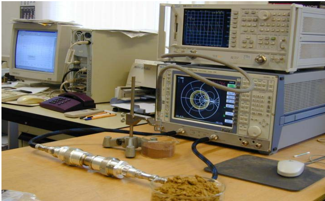
Bild 3.1 Netzwerkanalysator mit Messleitung, offener Koax-Sonde und angeschlossener Messwertverarbeitung
