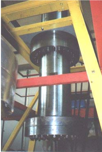
Bild 2 Halbtechnische Anlage für Lastabtrag und Permeabilität (HALP 1)
