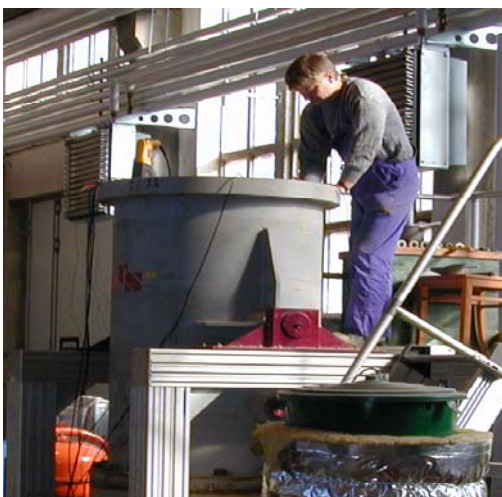
Bild 11.4 Einbau von binärem Gemisch und Bandkabeln in die großkalibrige Permeabilitätsapparatur
