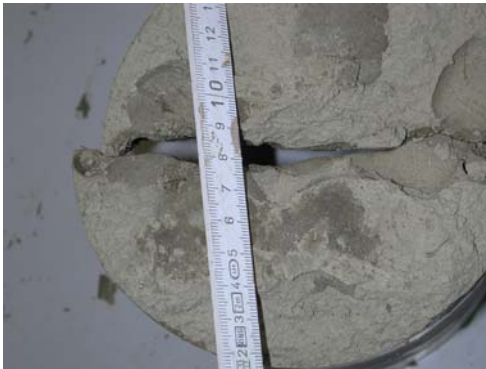
Bild 10.21 Bestimmung von Feuchtegehalt und Dichte vom ausgebauten Material über der Länge des Druckrohres
