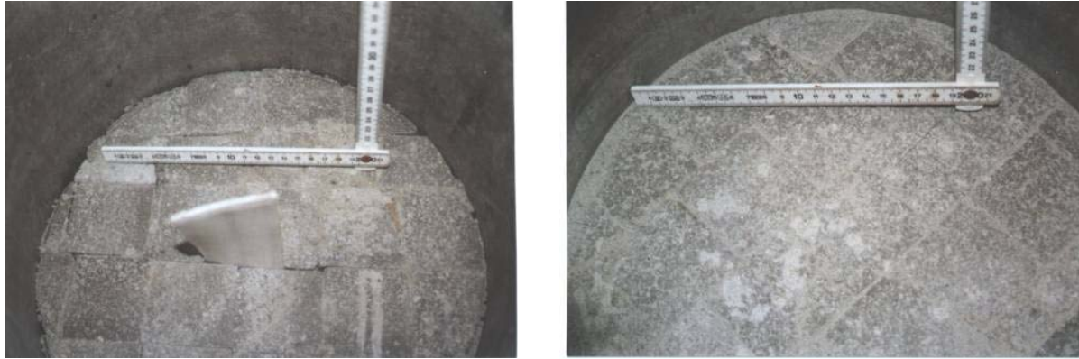
Bild 11.6 Einbau der Bentonitformsteine im Versuch KU 4 (links: mit Kabelsensor, rechts: mit Granulat verfüllte Oberfläche der Druckseite)
