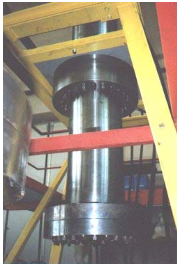
Bild 11.2 Halbtechnische Anlage für Lastabtrag und Permeabilität (HALP 1)
