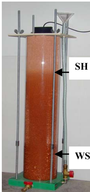
Bild 8.27 a) Versuchsstand für das kapillare Saugen; b) Vergleich der Impulsantworten von Luft, trockenem Seramis und feuchtem Seramis nach dem Einfüllen von 7 Liter Wasser (SH-Saughöhe; WS -Wassersäule)
