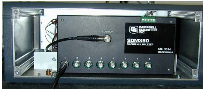
Bild 10.16 TDR-100 Messsystem mit Multiplexer
