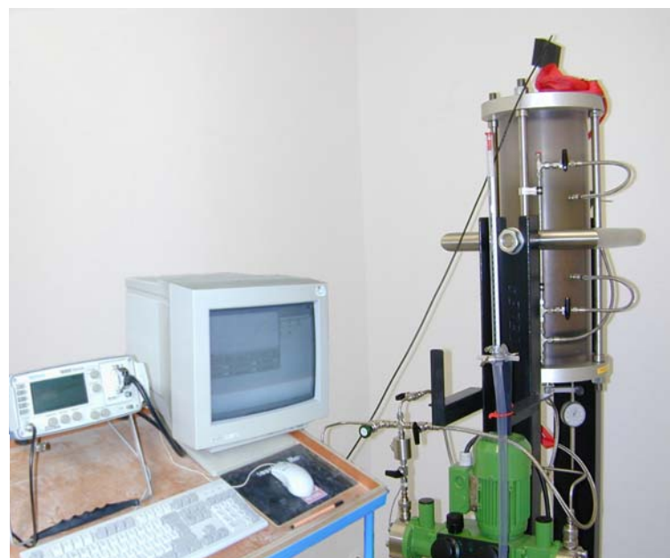
Bild 10.2 Druckversuchsstand mit Kabelsensor und Messwertverarbeitungseinheit
