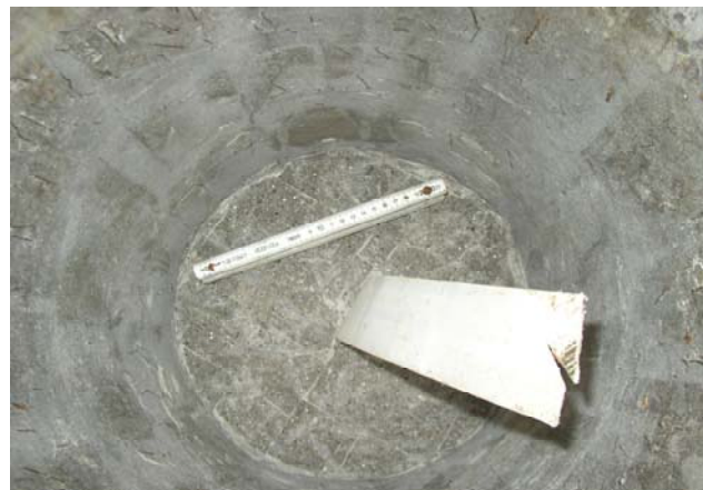
Bild 11.5 Halbtechnische Anlage für Lastabtrag und Permeabilität (HALP 1) mit eingebautem Sensor
