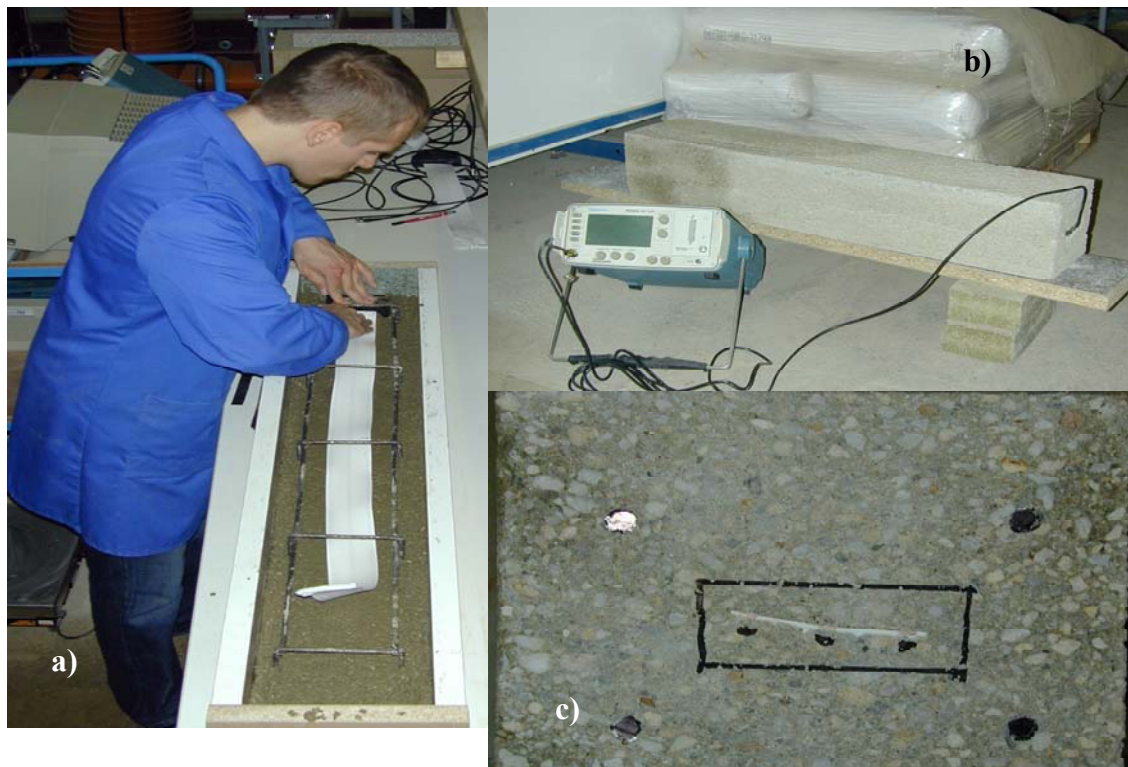
Bild 8.29 a) Einbau eines Kabelsensors in ein Betonprisma mit Drahtkorb; b) Versuchsaufbau nach Abnahme der Schalung; c) Messaufbau nach dem Ausschalen; c) Querschnitt mit Kabelsensor
