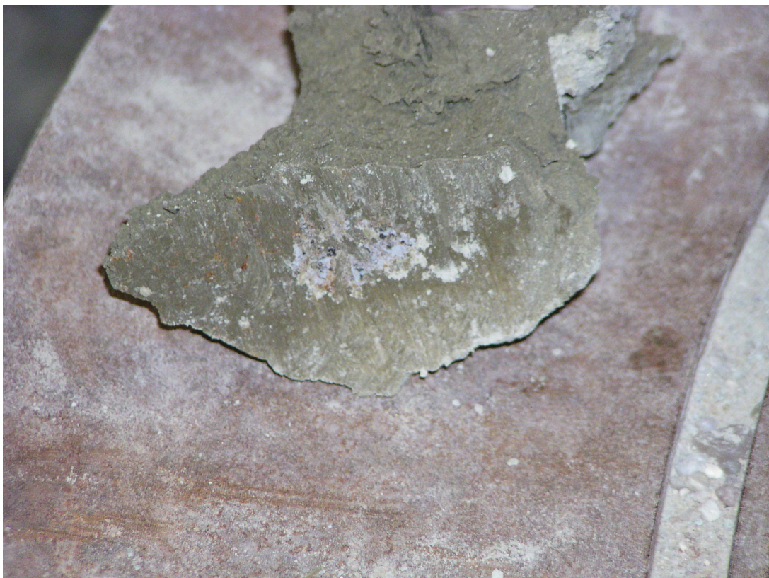
Bild 36 Bentonitprobe aus der Grenzschicht gesättigt - feucht
