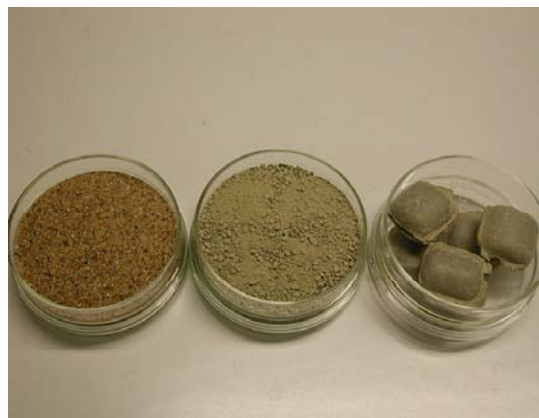
Bild 10.4 a) Schichtung im Druckversuchsstand b) Sand, Calcigel-Granulat, Calcigel-Pellets
