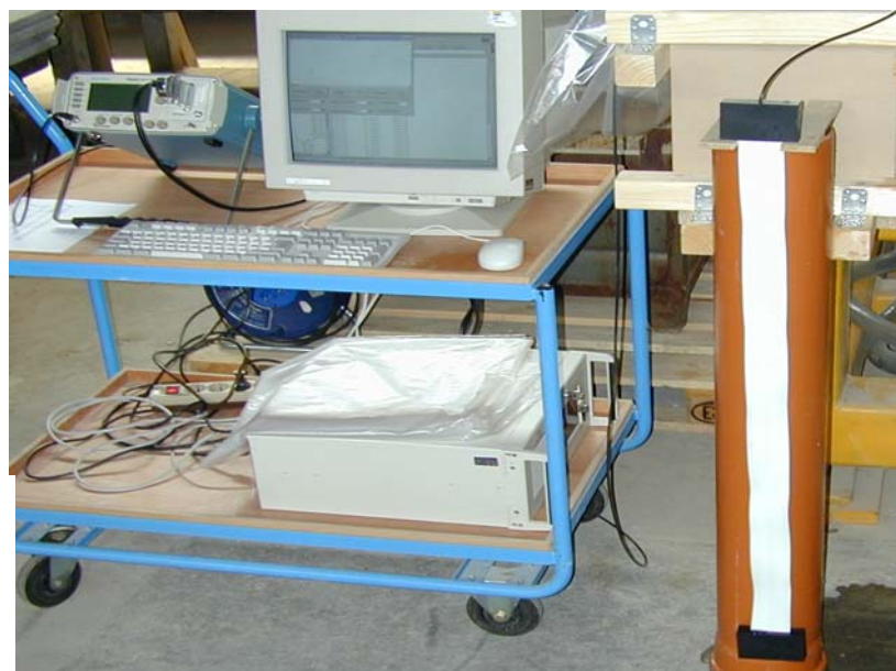
Bild 5.10 TDR-Messplatz mit Kabeltester, Computer und Bandleitung
