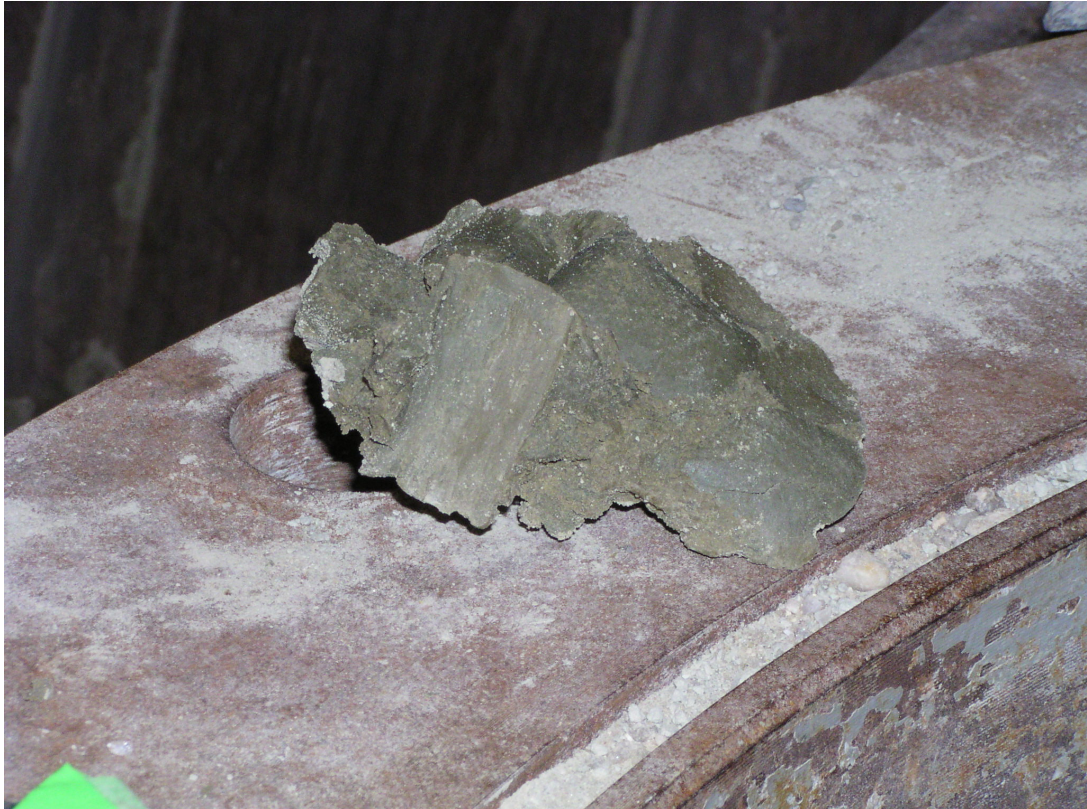
Bild 35 Bentonitprobe aus dem feuchten Bereich; Kissenstruktur noch erkennbar
