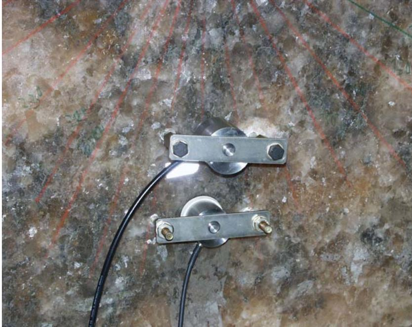
Abb. 4.1: Stapelaktuator (oben, hart gekoppelt) als Geosonar-Sender und niederfrequenter Ultraschall-Empfänger mit integriertem 28-dB-Vorverstärker (unten, Kopplung: Silikonkappe), Eigenentwicklungen der EADQ
