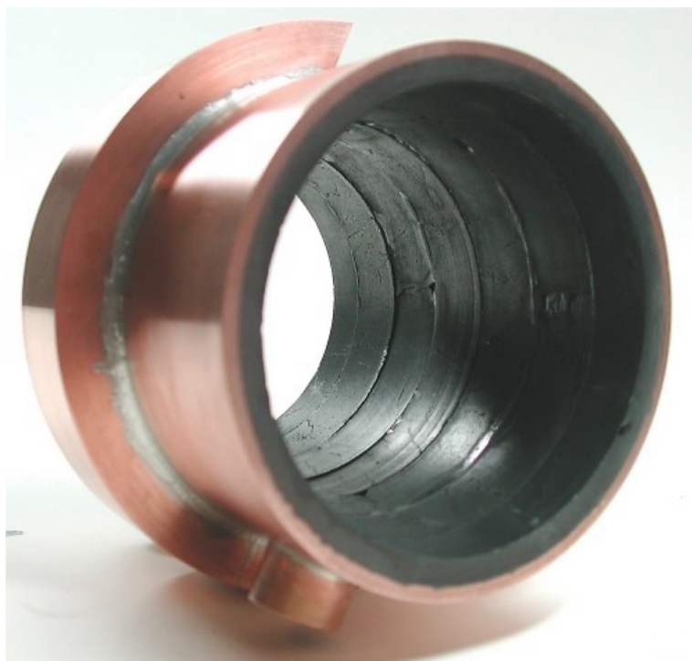
Bild 2.15 Kupferhülse mit integrierten Supraleiterringen
