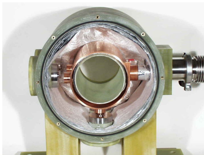
Bild 2.16 Partiiell geöffnetes Dewar mit Kupferhülse und Superisolation zur thermischen Entkopplung von der Umwelt. Rechts hinten ist der Wellschlauch zu sehen, in dem der vakuumisolierte Kupferstab vom Kaltkopf der Supraleiterummantelung zum Cryocooler verläuft.
