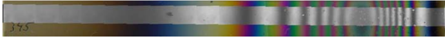
Bild 4.3: Fotografische Aufnahme einer Modellprobe mit stark inhomogener ZrO_2 -Verteilung. Der eingefügte s/w-Streifen stellt die Aufnahmen mittels monochromatischem Lichtmikroskop dar. Anhand der Anzahl der Interferenzordnungen (8 Auslöschungen) lässt sich die Schichtdicke im Verteilungsmaximum mit ca. 1,1 \mu m abschätzen.
