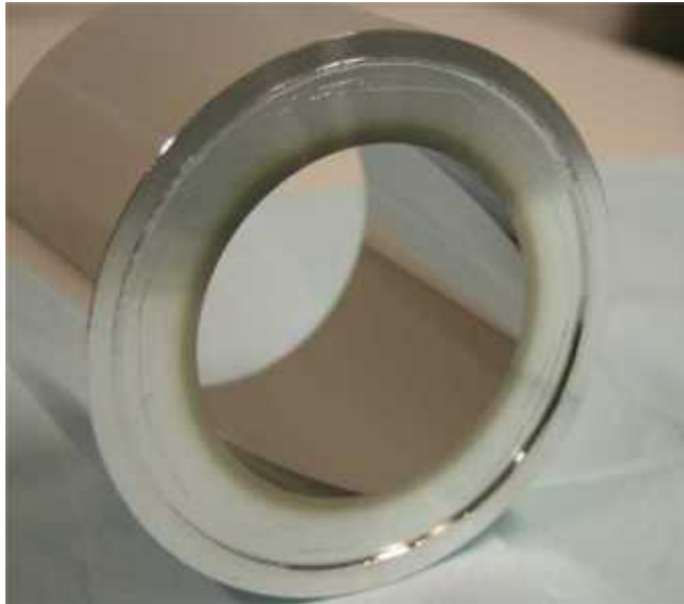
Bild 9.7: Innenbeschichtete EUV-Optik; Auf der rotations-elliptischen Innenfläche wurde mittels dem PLD-Verfahren eine 3 nm dicke Kohlenstoff-Deckschicht aufgebracht.
