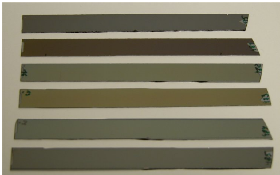
Bild 7.5: Testproben (polierte 95mm-Si-Streifen) mit bei verschiedenen Laser-Parametern homogen aufgetragenen C-Beschichtungen zur Charakterisierung der Schichteigenspannungen mittels Biegebalkenmethode.
