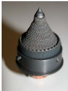
Bilder 7.23: Targeterosion nach der Schichtabscheidung bei \lambda = 355 \text{ nm} / E = 300 \text{ mJ} / \Phi = 9,7 \text{ GW/cm}^2 . Deutlich ersichtlich ist das „Eingraben“ der Rasterfläche nach unten, das mit einem erheblichen Partikelaustrag verbunden war.
