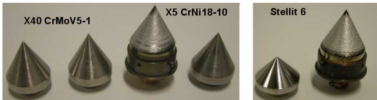
Bild 8.1: Edelstahl- und Hartmetall-Targets für die Innenbeschichtung mit verschiedenen Geometrien, z. T. in Cu-Targethalter und mit Raster Spuren des Ablationslasers.
