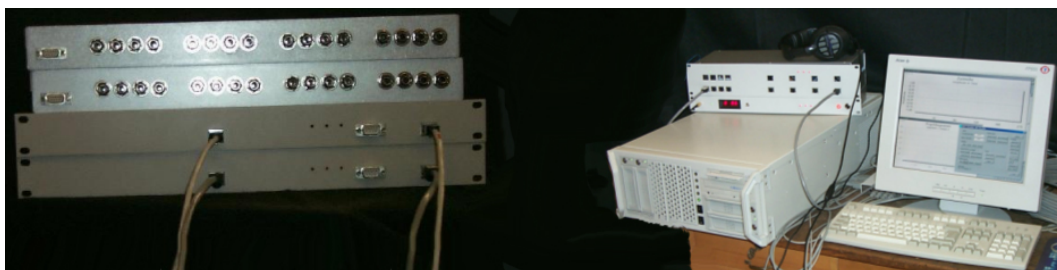
Abbildung 10: Bild der in Eigenkonstruktion gefertigten Messanlage. Links: Eingangskanäle; Rechts: Bedienoberfläche
