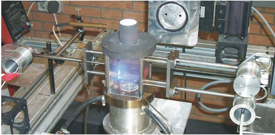
Abbildung 9: Sonden mit Mikrophon an Brennkammer während des Meßbetriebs
