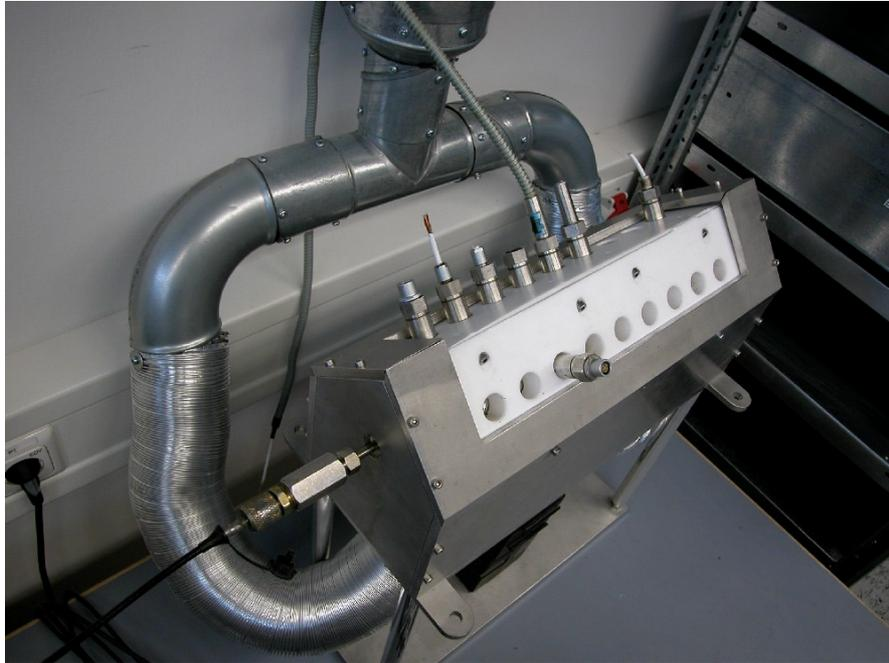
*Abb. 7: Dynamischer Drucksensor-Prüfstand für die isolierte Untersuchung des Thermoschock-Effektes*
